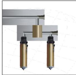
Bei natürlich balancierten Heißkanal-Verteilern kann es aufgrund von Schereinflüssen, abhängig von Material und Verarbeitungsparametern, zu einer ungleichmäßigen Formfüllung kommen.
