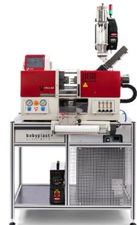
Oben: babyplast 6/12 PT mit Peripherie – komplette Produktoinsanlage für Kleinteile
