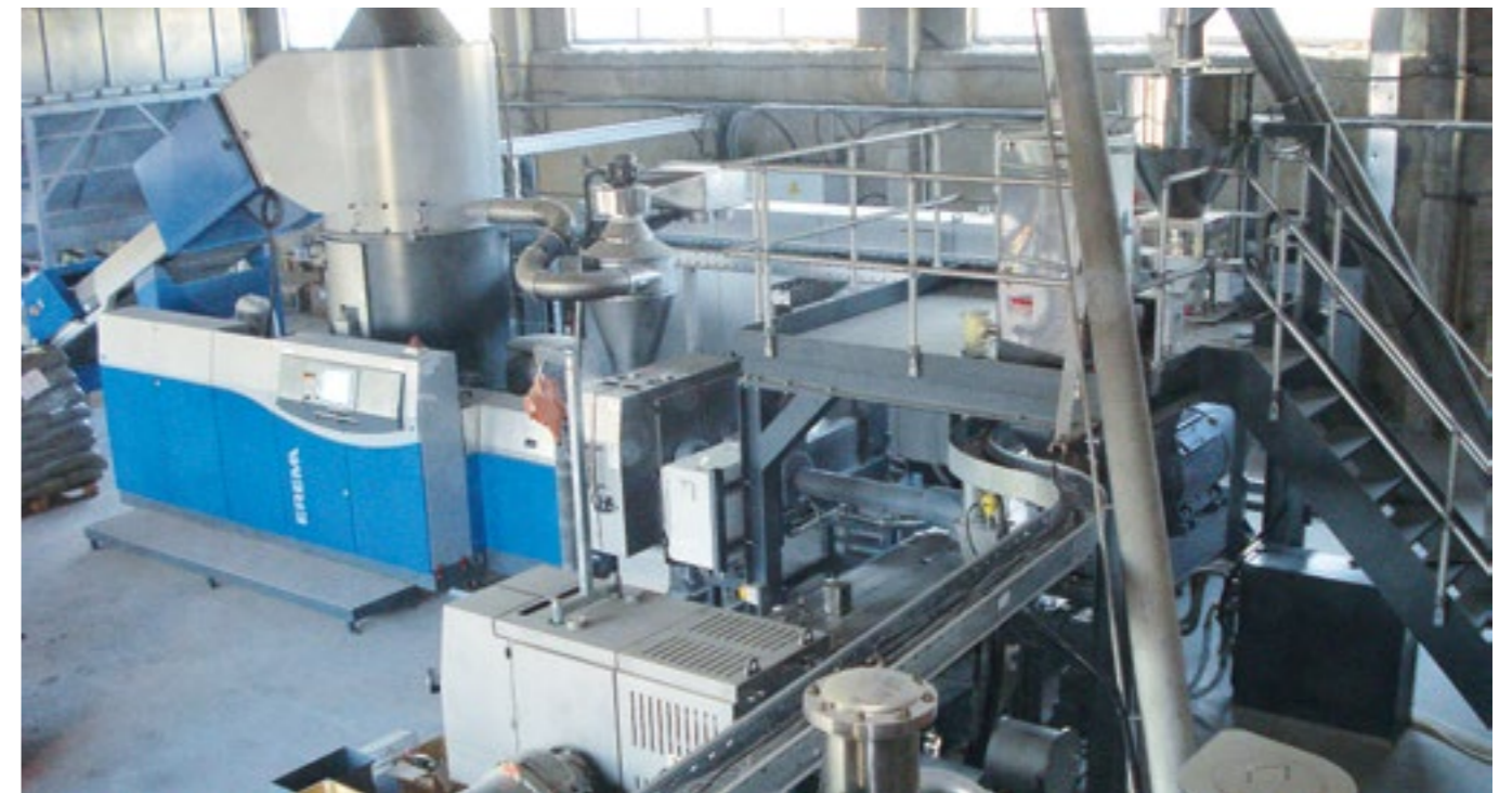
Die Kombination von Recycling und Compounding mit einer COREMA® 1514 T ermöglicht dem russischen Unternehmen aus PP Materialien direkt in einem Arbeitsschritt exakt spezifizierte Compounds herzustellen. Ein besonderer Vorteil ist die hohe Flexibilität des Systems in puncto unterschiedlicher Inputmaterialien
