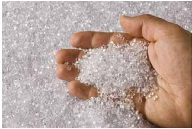
Lösemittelbasiertes Recycling ist ein effektiver und effizienter Schlüssel zur stofflichen Wiederverwertung von fremd- und schadstoffbehafteten Kunststoffprodukten wie expandiertes Polystyrol aus der Anwendung am Bau; © PolyStyreneLoop (links), EPC (rechts)
