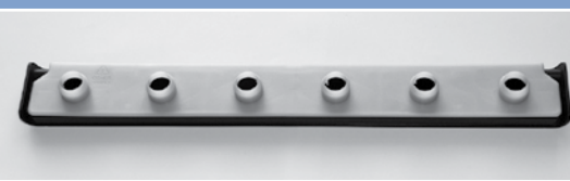
Abdeckung für KFZ-Batterien: Unterteil (schwarz) aus PP-Regnanulat, Teilgewicht 58,3 g + 1,5 g Anguss, und Abdeckung, (weiß) aus PP+TPE, Teilgewicht 26,3 g + 1,5 g Anguss; beide gefertigt in 4 Kavitäten, mit einem Zyklus zwischen 24 und 30 Sekunden
