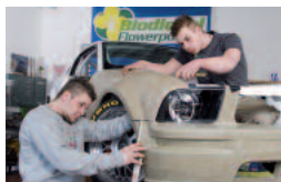
Das BioConcept-Car aus naturfaserverstärktem Material
