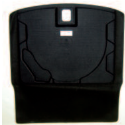
VW Touran, Ablegeboden, Sandwichbauweise
