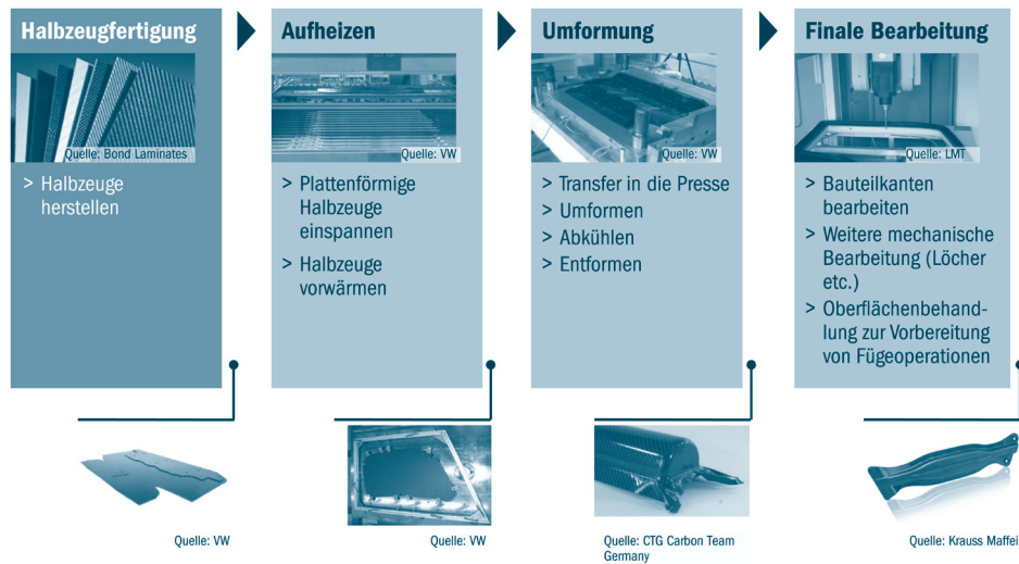
Abbildung 26: Heutiger Prozess: Thermoplast-Formpressen
