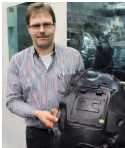
ALBERT BURGHART, Werksleiter bei KTW in Weißenburg, zeigt sich zufrieden: Mit der adaptiven Prozessführung APC lassen sich auch Rezyklate durchgehend zu qualitativ hochwertigen Bauteilen verarbeiten.
