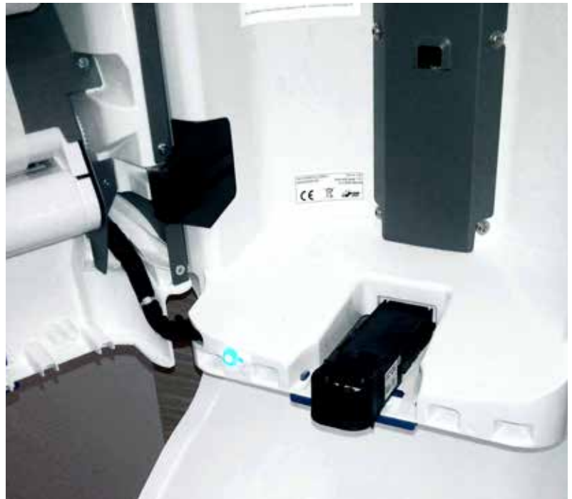
Das Gehäuse, das die Elektronik und Sensorik schützt (rechts), und die Dosiereinheit für die Seife (darunter) sind aus glasfaserverstärktem Technyl® One PA66/6T. Die Scharniere (links), die den Papiervorratsbehälter mit dem Gehäuse verbinden, sind aus glasfaserverstärktem Technyl® Exten PA610.
