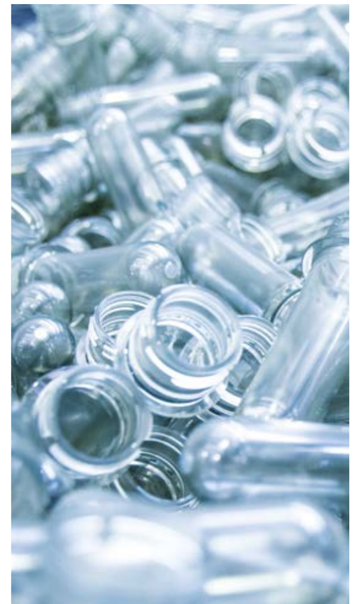
Mit der PET Inline Preform Anlage ist eine flexible Direktverarbeitung von PET Flakes zu lebensmittelkonformen Inline Preforms in nur einem Verarbeitungsschritt möglich.
