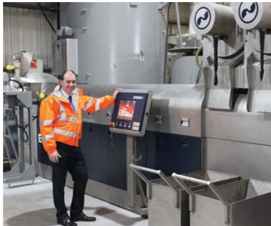
Mark Roberts, Geschäftsführer von PLASgran ist mit der Performance seiner neuen Maschine sichtlich zufrieden: 2.500 Kilogramm pro Stunde erreicht die neue INTAREMA® 2018 TVEplus® RegrindPro® beim Mahlgut-Spezialisten in UK.
