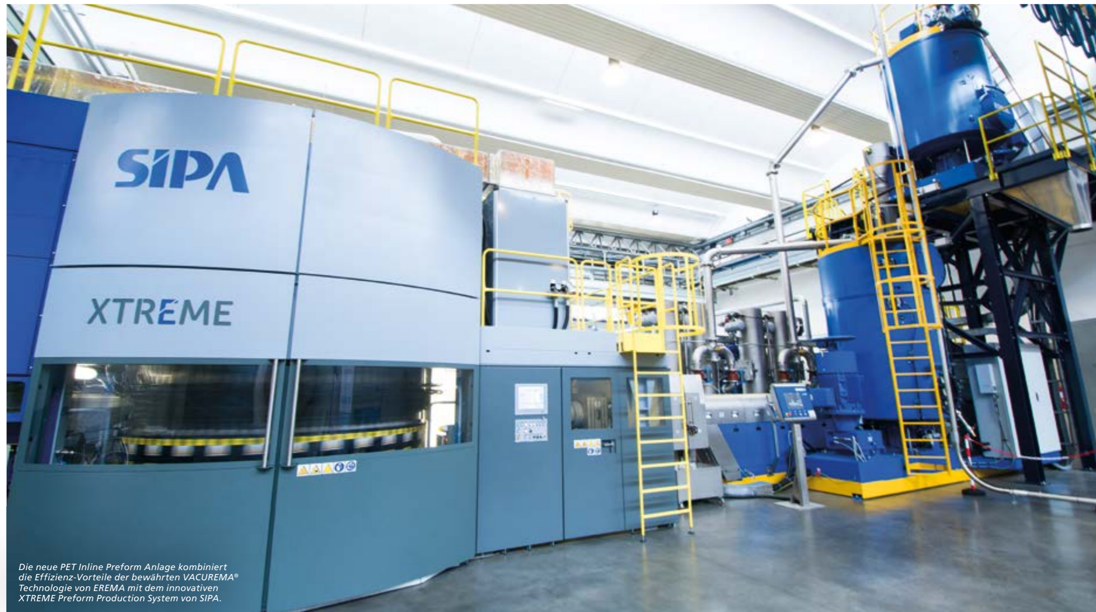
Mit der PET Inline Preform Anlage ist eine flexible Direktverarbeitung von PET Flakes zu lebensmittelkonformen Inline Preforms in nur einem Verarbeitungsschritt möglich.
