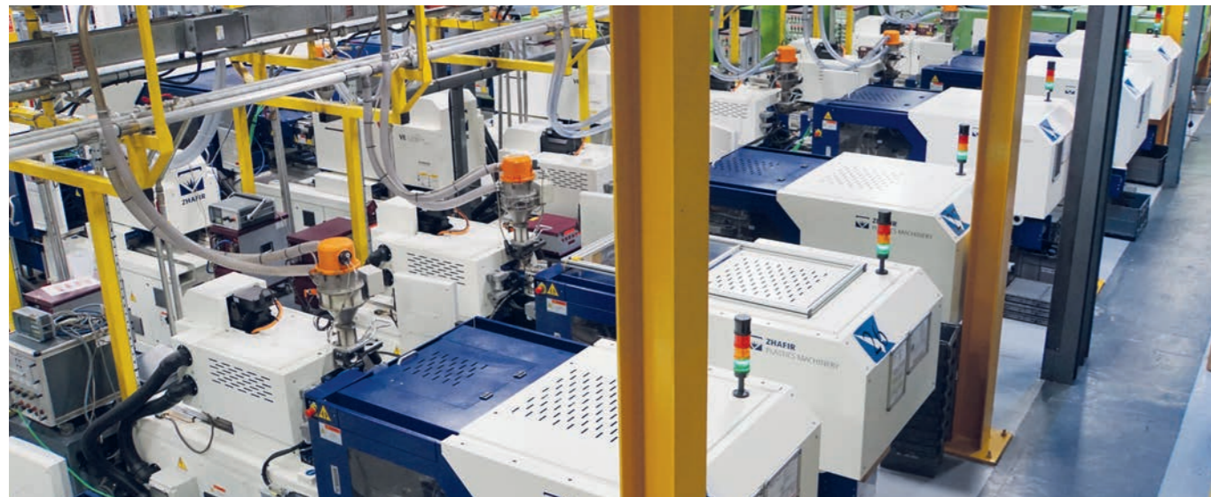
17 elektrische Spritzgießmaschinen tragen das Logo der Zhafir Venus II Serie und arbeiten mit Schließkräften von 600 bis 1.200 kN.
