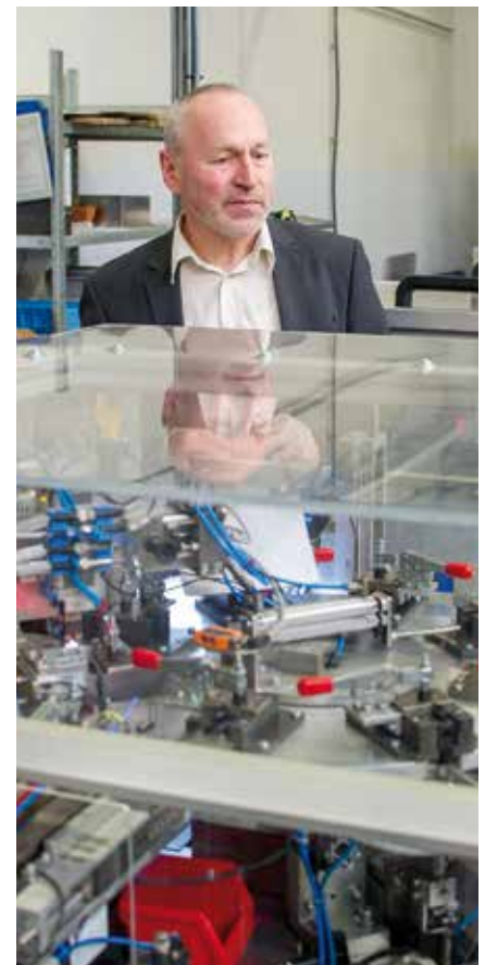
Mit einem hohen Grad an Automatisierung gestaltet FEP die Herstellung der Steckverbinder wirtschaftlich: Halb- oder vollautomatische Einlegeprozesse gehören ebenso dazu wie Stanzen und Sortieren.
