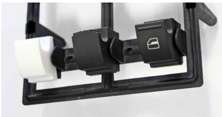
Wippschalter für elektrische Fensterheber: Weiße unlackierte Formteile (links), Formteile nach der Lackierung (Mitte), mit Laserstrahl freigelegte Symbole auf der Sichtfläche (rechts).
