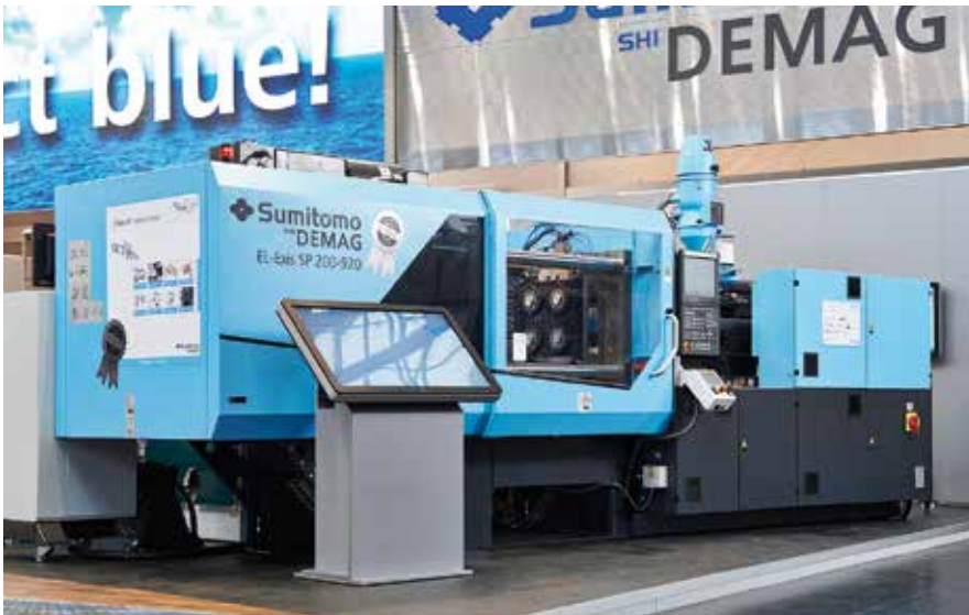
Die EL-Exis SP ist für schnellaufende Verpackungsanwendungen konzipiert.
