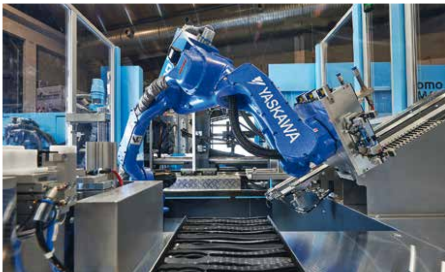
Der Roboter sorgt für das Handling der Einleger und halbfertigen Teile.
