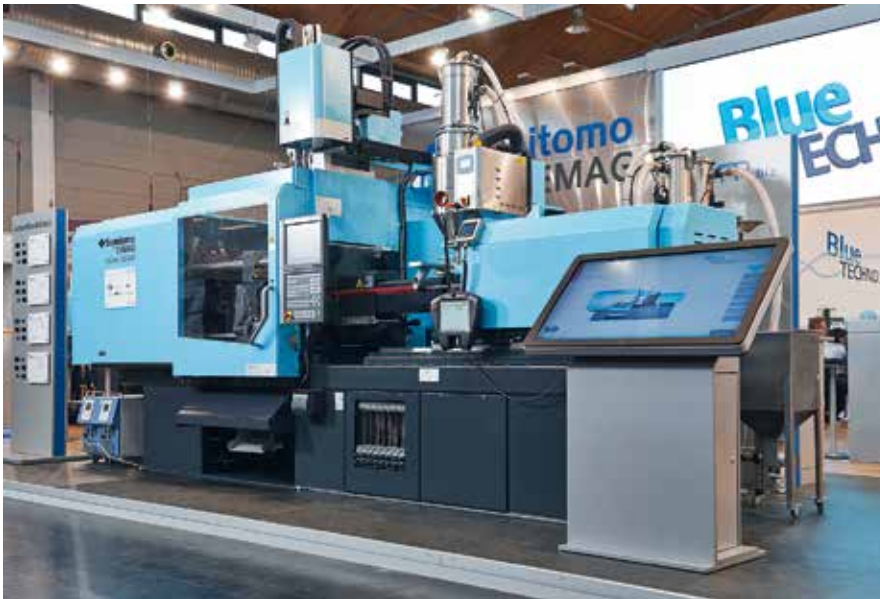
IntElect 100-340 zur Fertigung eines Steckers in einem 4-fach-Werkzeug.
