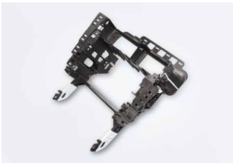
2K-Formteil für die Mittelkonsole des Modells Q5 RL von Audi. Um Knarzeräusche zu verhindern, wird das Bauteil mit einer Weichkomponente aus TPE ausgestattet (weiße Bereiche).
