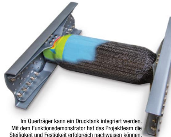
Im Querträger kann ein Drucktank integriert werden. Mit dem Funktionsdemonstrator hat das Projektteam die Steifigkeit und Festigkeit erfolgreich nachweisen können.
