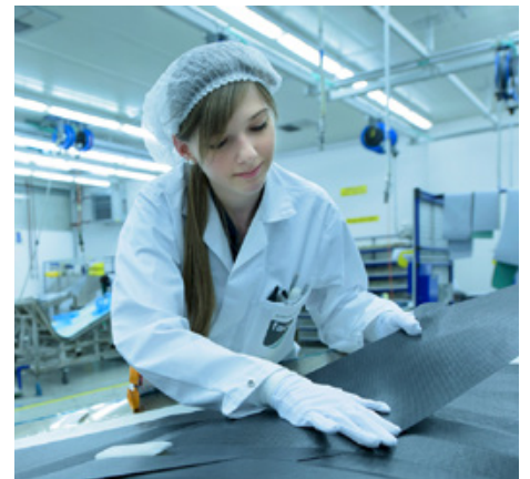
FACC ist ein führender Hersteller von innovativen Leichtbauteilen für Flugzeuge und Hubschrauber – im Bild: Fertigung eines treibstoffsparenden Winglets. Bild: FACC
