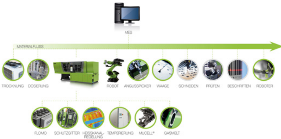
In der Fabrik der Zukunft sind Maschinen, Geräte und Systeme nicht länger sternförmig miteinander verknüpft, sondern sie bilden ein großes Anlagen-Netzwerk, in dem sie über OPC UA kommunizieren. Bild: ENGEL
