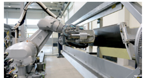
Robotereinsatz bei zerstörungsfreien Materialprüfungen. Bild: Fill
