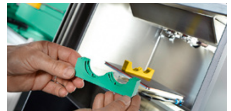
Besonderes Verfahren der additiven Fertigung: Der free-former von Arburg fertigt das Bauteil auf Basis von 3D-CAD-Daten aus kleinsten Tropfen. Bild: ARBURG
