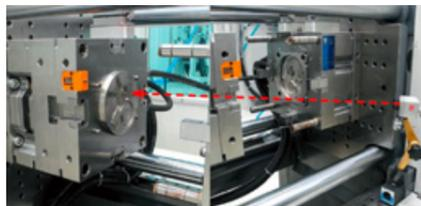
Um die Werkzeugtemperierung und der Einfluss auf die Zykluszeit, Verzug, Bauteilfestigkeit zu messen, wird das IR Thermo-Control System eingesetzt. Temperaturen werden online aufgezeichnet, womit klare Optimierungsmaßnahmen abgeleitet werden können. Bild: Plexpert
