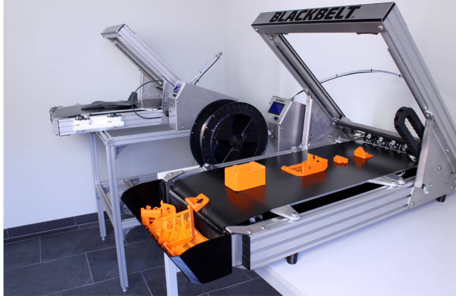
3D-Druck am laufenden Band. Durch den Fördergurt ist auch die Produktion von endlosen Bauteilen möglich. Bild: Blackbelt 3D BV
