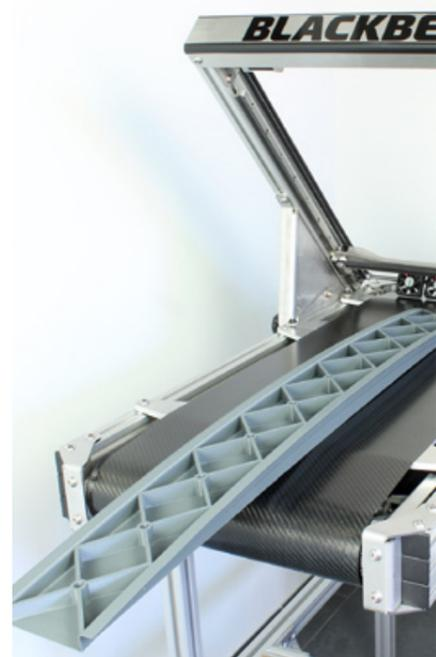
Ein Fördergurt ermöglicht die Produktion von endlosen Bauteilen. Bild: Blackbelt 3D BV
