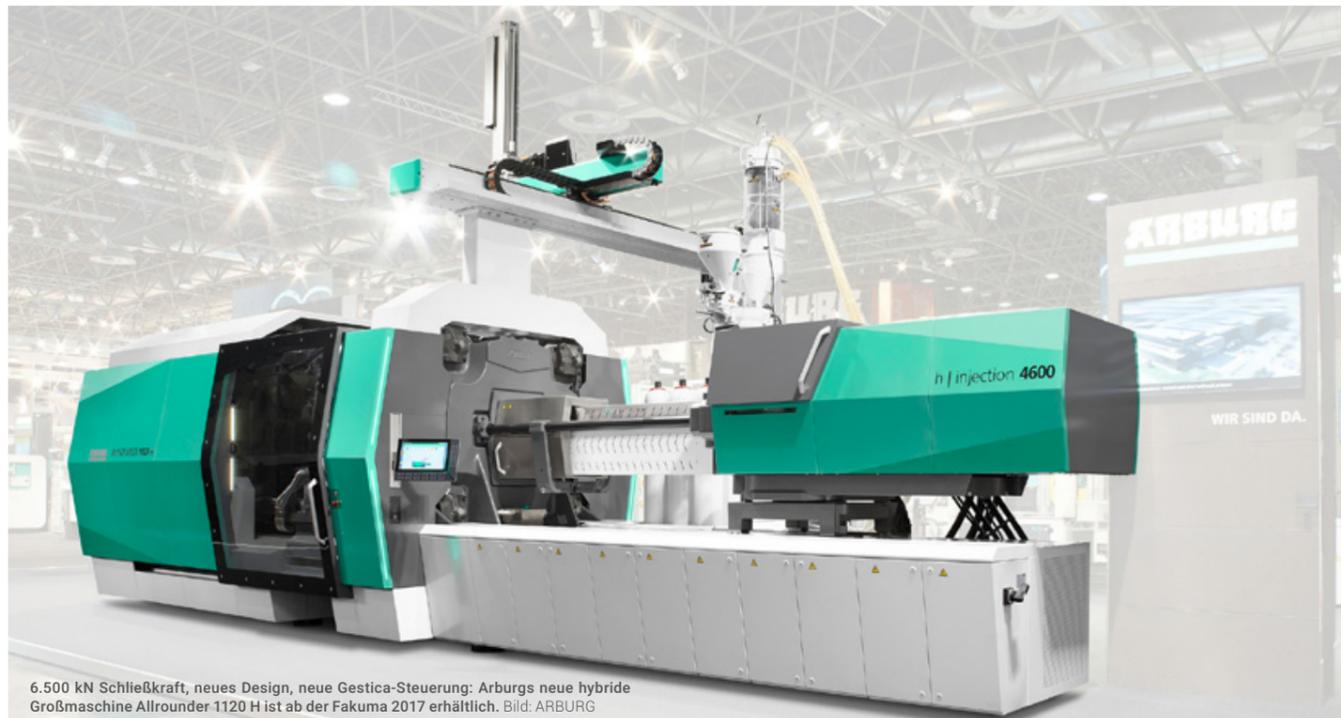
6.500 kN Schließkraft, neues Design, neue Gestica-Steuerung: Arburgs neue hybride Großmaschine Allrounder 1120 H ist ab der Fakuma 2017 erhältlich. Bild: ARBURG
