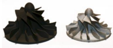
Metalldruck mittels Filament Metal Printing (FMP). Bild: BASF
