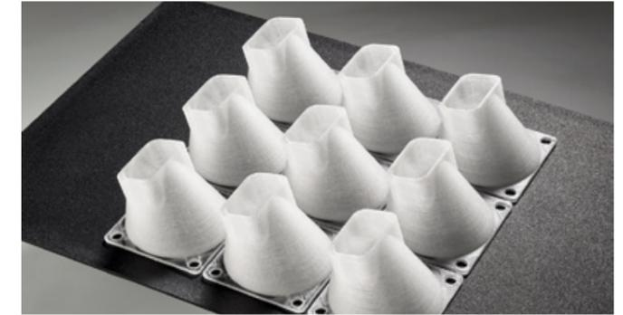
Für den Anwendungsbereich Raum- und Luftfahrt fertigt ein Freeformer exemplarisch Luftkanäle aus einem speziell zugelassenen PC. Bild: ARBURG
