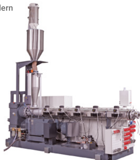
Die solEX NG Extruderserie ist nahezu baugleich mit der bewährten solEX Reihe. Hierdurch ergibt sich die Möglichkeit, bereits vorhandene Maschinen mit der neuen Verfahrenstechnologie aufzurüsten. Bild: battenfeld-cincinnati
