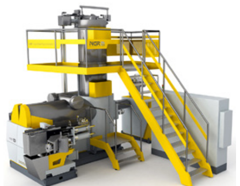
P:REACT ermöglicht das Up-Recycling von PET mit Eigenschaften, welche besser sind als jene vom Ausgangsmaterial. Bild: NGR
