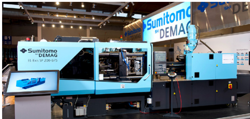
Die EL-Exis SP 200 überzeugt durch extrem schnelles In-Mould-Labeling. Bild: Sumitomo (SHI) Demag
