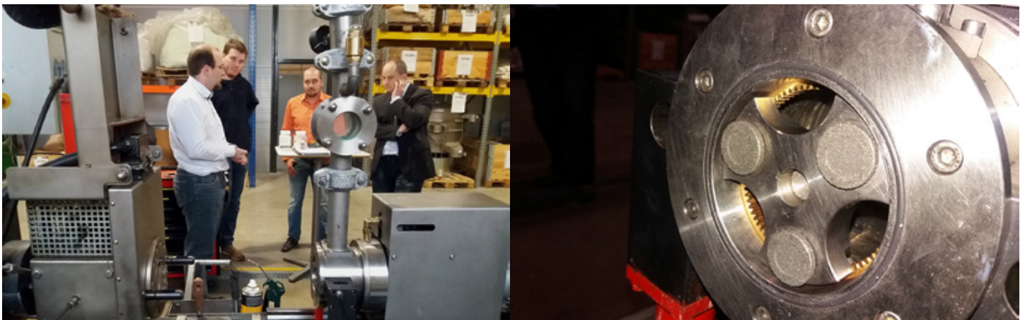
Technikumsanlage mit der installierten Schleif-Vorrichtung samt Schleifscheiben. Bild: Sustainable Innovation e.U./W. Ahrer
