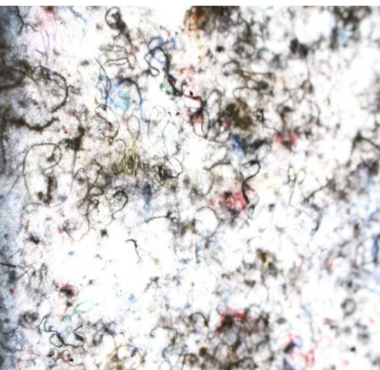
Faserförmiges Mikroplastik (Länge < 5 mm) gelangt z. B. bei der Produktion, Pflege und Nutzung eines Stoffes/Textils unbeabsichtigt in die Umwelt.
