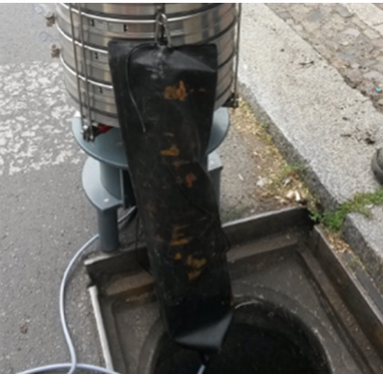
Probenahmekorb zur Beprobung von Straßenkehricht.
