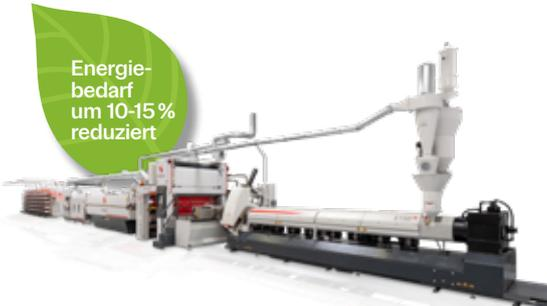
Für die Bändchenanlage starEX (Sparte textile packaging) wurde beispielsweise das patentierte eqoSTRETCH Modul entwickelt: Mit der vollständigen Einhausung der Heizgaletten wird die Wärmeabstrahlung auf ein Minimum und der Energiebedarf um 10-15 % reduziert. Außerdem wurde diese Maschine mit einer Wärmepumpe zur Wärmerückgewinnung ausgestattet.
