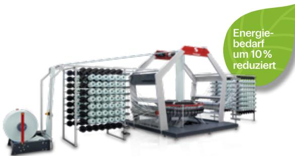
Bei der neuen Rundwebmaschine FXa 6.0 konnte der Energiebedarf zum Weben durch eine Fachbildungsmechanik im Gegensatz zur FX 6.0 um ca. 10% gesenkt werden. Zusätzlich wurde das eqoMODUL für die Bändchenanlage StarEX entwickelt: Dieses ermöglicht eine Einsparung von 240 Litern Thermoöl über die gesamte Lebensdauer der Maschine und ein ölfreies Wärmeübertragungssystem.
