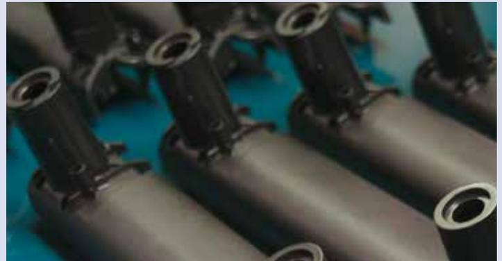
Der Grundkörper des Türzuziehgriffs für T6 Multivan und Nutzfahrzeug (hier im Bild) wird mittels Gasinnendrucktechnik hergestellt
