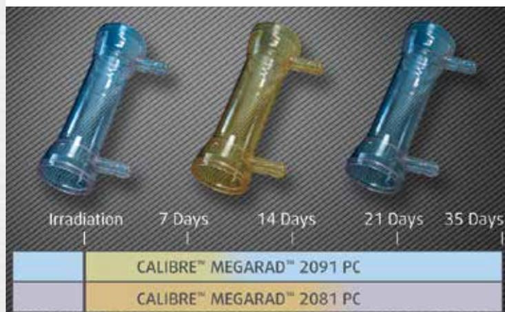
Nach Einwirkung einer einstufigen Standard-Gammasterilisation zeigt das neue Polycarbonat CALIBRE™ MEGARAD™ 2091 eine um 25% schnellere Rückkehr zur spezifizierten Farbe als andere strahlenstabilisierte Produkte. (Dokumentation auf Anfrage verfügbar)
