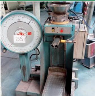
Lot 39 : ensacheuse analogique bag filling machine 50 kg / 50 g
