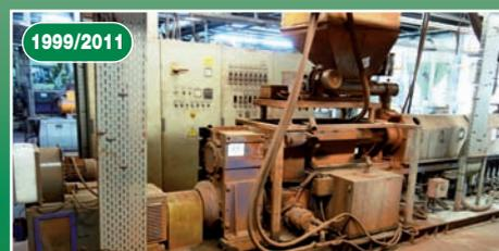
Lot 73 : extrudeuse bi-vis twin screw extruder COMAC 90/37D
