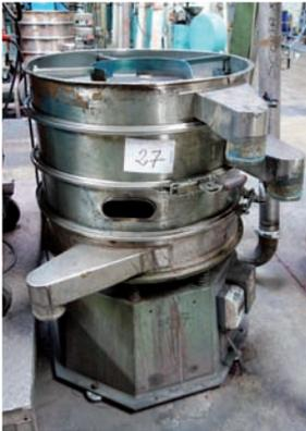
Lot 27 : tamis vibrant vibrating screen 4 niveaux, ø 800 mm
