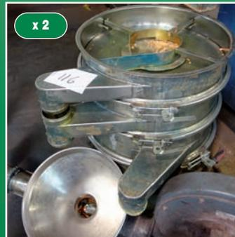
Lot 116 : tamis vibrant vibrating screen 3 niveaux, ø 500 mm
