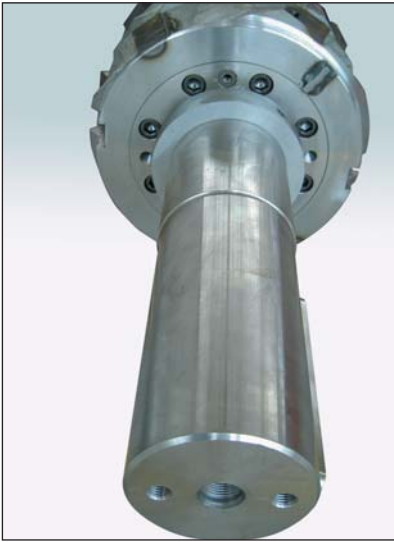
Bild 2: Einwellenzerkleinerer der Baureihe WLK - Geschraubter Wellenzapfen
