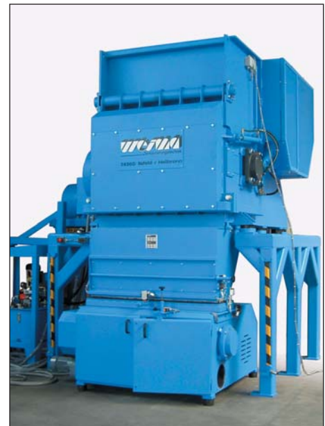
Bild 1: Zweistufige Zerkleinerung mit Universalzerkleinerer WLK und Nachzerkleinerer NZ, übereinander angeordnet
