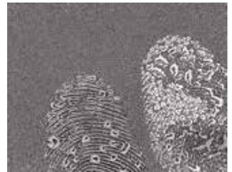
Detektion von Fingerabdrücken auf CFK-Oberflächen mittels Aerosol-Benetzungsprüfung
