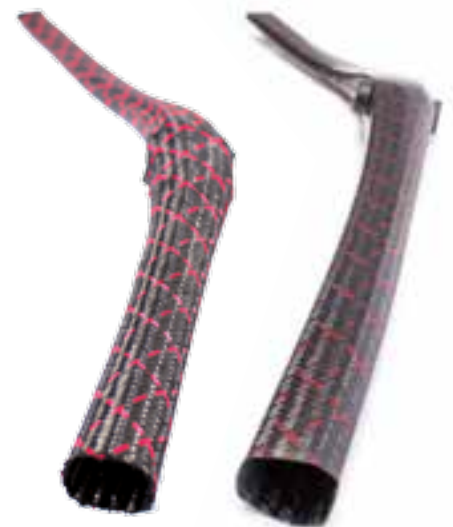
Hohle Preforms mit variablen Querschnitten (l.) sind ebenso möglich wie verklebte Bauteilgruppen (r.)
