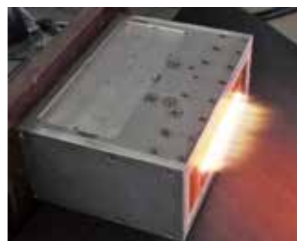
Abb. 3: Large-Plasmaquelle zur Hochrate-Plasmaaktivierung
