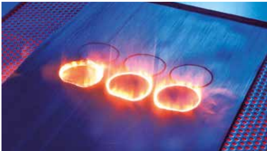
Abb. 1: Laserzuschnitt von thermoplastischen CFK-Prepregs mittels remocut®FRP-Technologie
