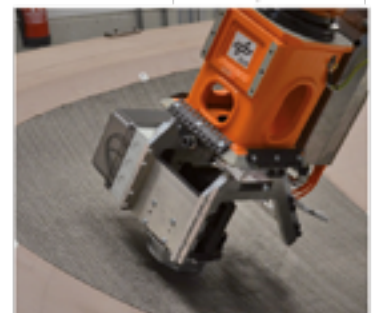
Produktionsintegrierte Qualitätssicherung: Laserlichtschnittverfahren, Faserwinkelmessung
