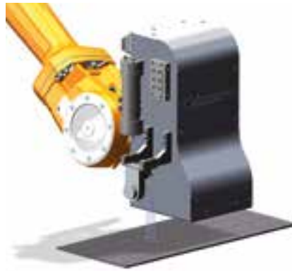
Roboter geführter BoNDTinspect-Prüfkopf
