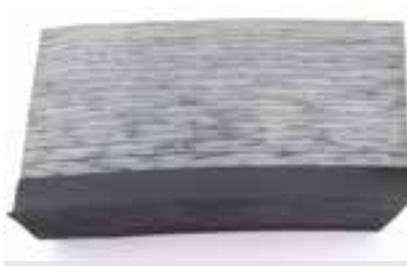
Infusion bis 50 mm Wanddicke auf EPDM-Liner
