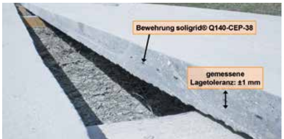
Bild 2: Aufgeschnittene Fassadenplatte zur Überprüfung der Lagetoleranz
