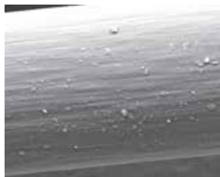
Faseroberfläche nach der Präparation mit Monomerenlösung
