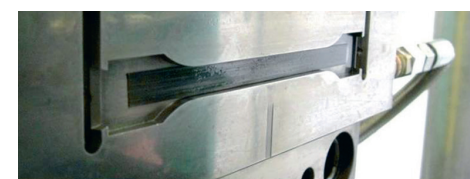
Haftendes Tape im Werkzeug dank EMS-Tapefix.
