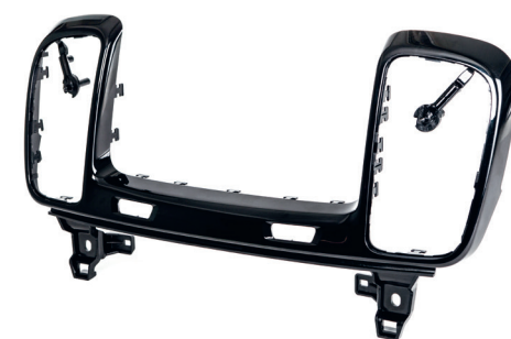
Abdeckung Mittelkonsole im Mercedes GLE.
