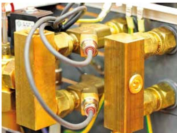
Bild links: Eine Kunststoffabdeckung schützt den 5,7" Touchscreen des Temperiergeräts. Bild rechts: Blick ins Innere des TEMPRO plus D: die neue Ultraschall-Doppel-Durchflussmessung von WITTMANN.
