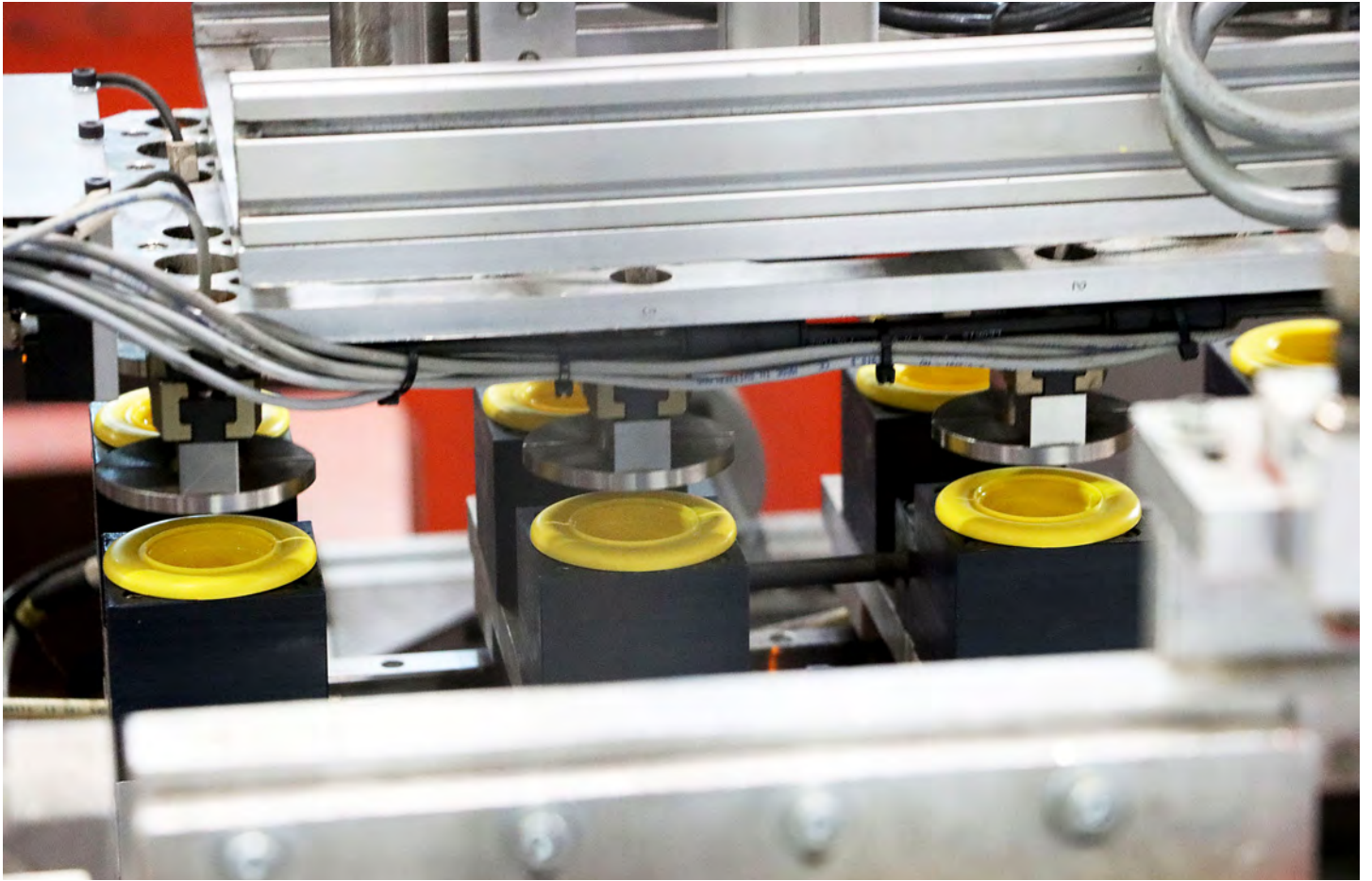
Der Greifer eines WITTMANN Entnahmeroboters nimmt Radfelgen für Spielzeugautos auf.
