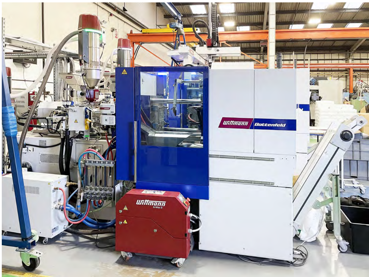
SmartPower 60 Ingrinder System, bestehend aus einer SmartPower Spritzgießmaschine mit 60 Tonnen Schließkraft, einer G-Max 9 Mühle, einem Feedmax S3 net Fördergerät, einem TEMPRO Temperiergerät und einem Angusspicker sowie einem Durchflussregler, alles von der WITTMANN Gruppe – installiert im Werk von Rugby Plastics in Leicester, UK.
