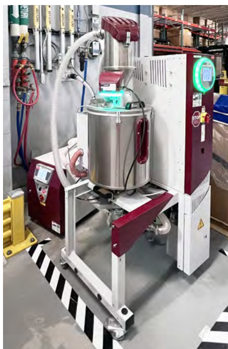
WITTMANN Granulattrockner mit Feedmax Materialfördergerät, dahinter ein Tempo Temperiergerät.
