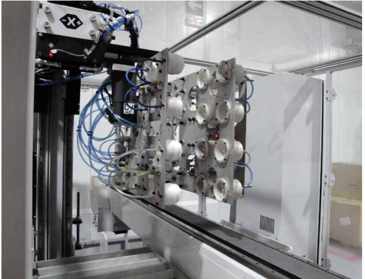
Robot-Greifer zur Entnahme der Fertigteile aus dem Werkzeug und zur anschließenden Ablage.
