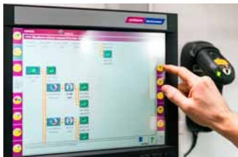
*WITTMANN M7.3 IPC Touchscreen-Netzwerksteuerung. Rechts davon ein an der Wand montierter Barcode-Scanner.*
