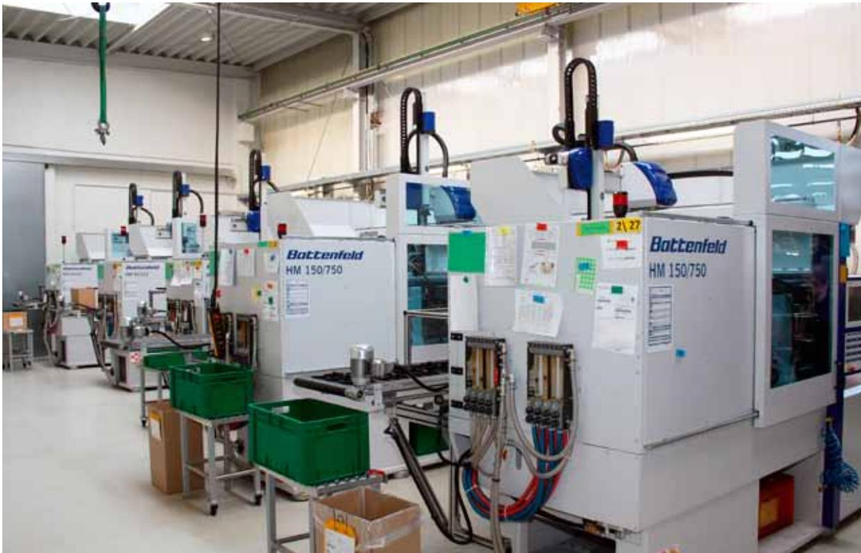
*Platzsparende Technik: Auf 220 m<sup>2</sup> konnten insgesamt sechs kompakte Insider Spritzgießzellen mit Schließkräften zwischen 900 und 1.800 kN untergebracht werden.*
