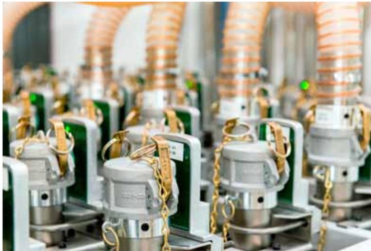
des Kupplungsbahnhofs an die unterschiedlichen Trocknungssilos angeschlossen. Der kodierte Kupplungsbahnhof CODEMAX von WITTMANN verhindert falsche Verbindungen zwischen Materialtrocknungssilos und Verarbeitungs-
