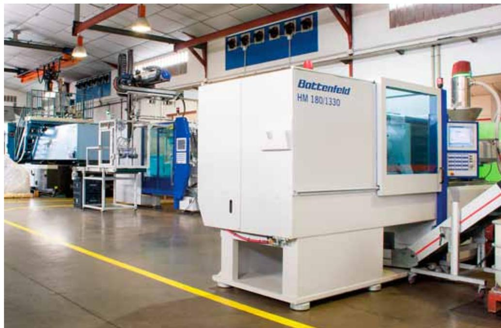
es sich um eine *MacroPower* 500T/8800 Spritzgießmaschine, die zur Produktion groß dimensionierter PVC-Teile eingesetzt wird, und die mit einem WITTMANN Servo-Roboter der neuesten Generation ausgestattet ist. Schließlich konnten zuletzt, im Jahr 2016, eine *SmartPower* 180T/1000 und eine HM 180T/1330 von WITTMANN BATTENFELD erfolgreich installiert werden. Darü-
