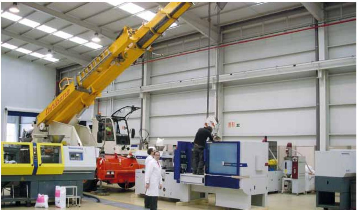
*Installation der EcoPower Spritzgießmaschine bei Fushima. (In seiner in Guarnizo in Nordspanien angesiedelten Produktion verfügt Fushima über 14 BATTENFELD-Maschinen.)*
