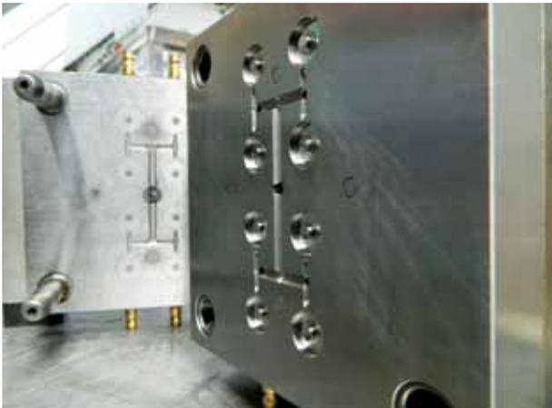
*Eines der bei Tielke im eigenen Werkzeugbau gefertigten Werkzeuge.*
