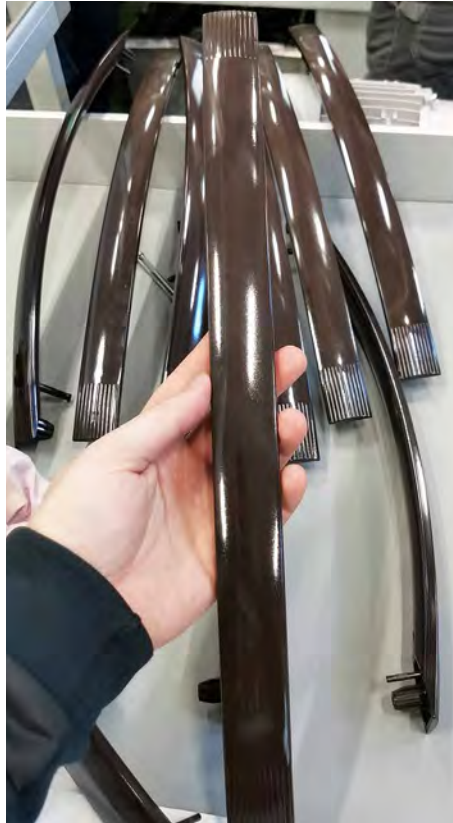
Bei GEFEST spritzgegossene Türgriffe für Haushaltsgeräte, für deren Herstellung die WITTMANN BATTENFELD AIRMOULD® Technologie zum Einsatz kommt.
