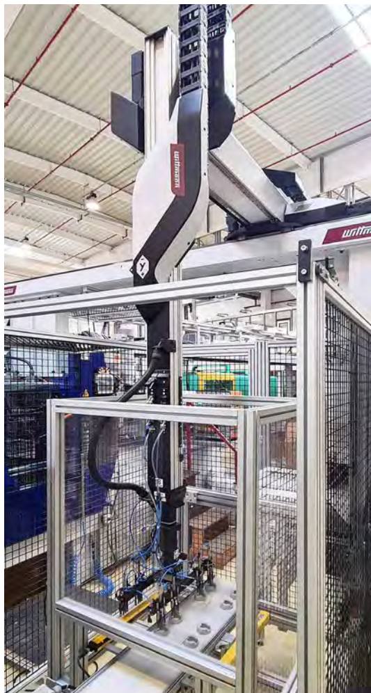
Handling von Flakon-Verschüssen: Ablage der Teile auf ein Fließband innerhalb einer sicheren Umgebung.
