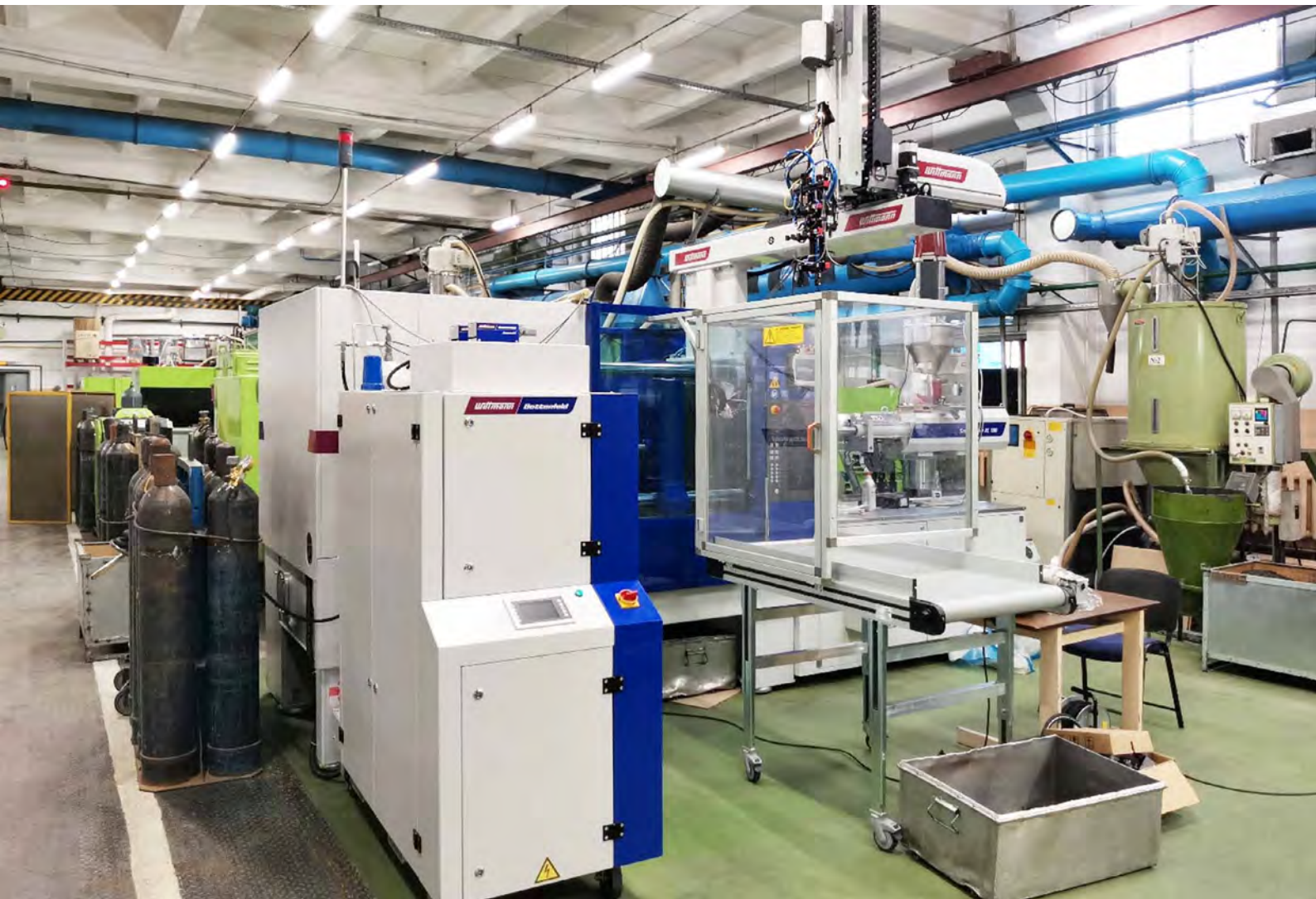
Arbeitszelle am Produktionsstandort von GEFEST in Brest, Weißrussland, bestehend aus einer WITTMANN BATTENFELD SmartPower XL180 Spritzgießmaschine und einem WITTMANN PRIMUS 26T Roboter sowie weiteren WITTMANN Peripheriegeräten wie Förder- und Temperiergeräten.
