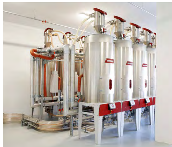
Ansichten der bei CER in Curtea de Arges installierten WITTMANN Zentralförder- und Trocknungsanlage.
