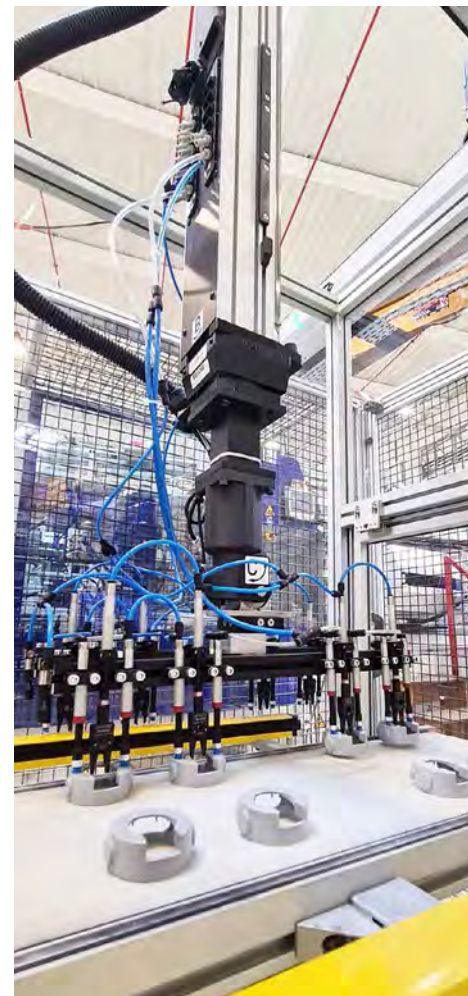
Handling von Flakon-Verschüssen: Ablage der Teile auf ein Fließband innerhalb einer sicheren Umgebung.
