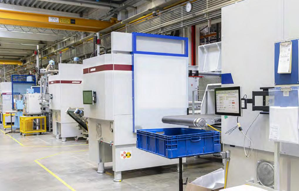
**Blick in die FUSO Produktion in Ybbsitz, Niederösterreich: SmartPower Maschinen von WITTMANN BATTENFELD in Insider-Ausführung mit WITTMANN Linearrobotern.**
