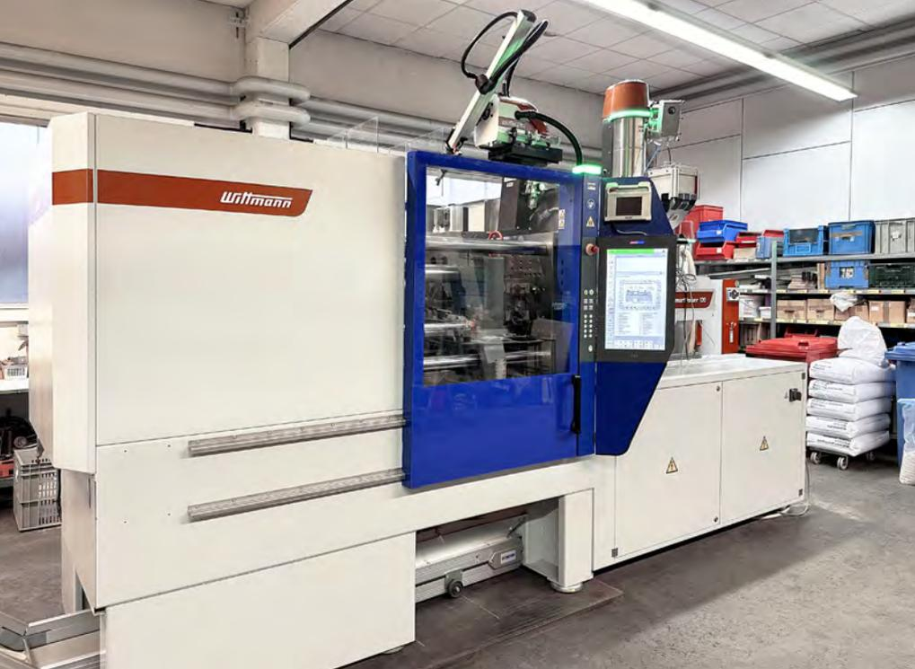
Herzstück der Produktionszelle ist eine SmartPower Spritzgießmaschine mit Angusspicker. Aufgrund der hohen Energieeffizienz der servohydraulischen Maschine konnte RING Kamm und Haarschmuck vom Förderprogramm der Bundesregierung profitieren.
