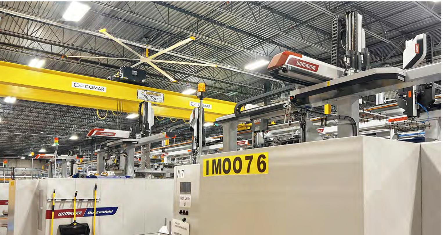
Jede der vier neuen Maschinen bei Comar in West Bend ist mit zwei W833 pro High-Speed-Robotern ausgestattet.
