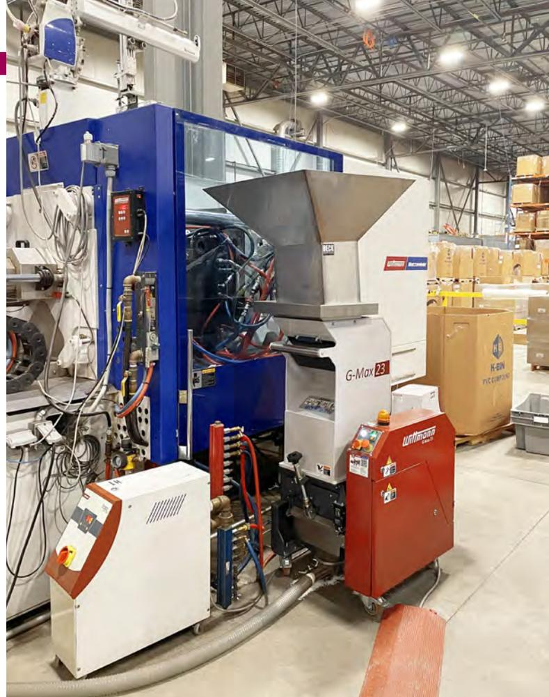
TEMPRO primus C120 Temperiergerät und G-Max 23 Mühle neben einer EcoPower 240 Spritzgießmaschine.
