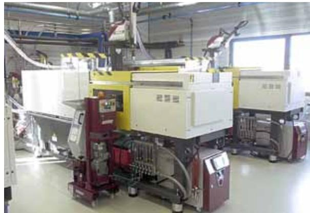
Trocknung des Materials, bevor es zu den Verarbeitungsmaschinen gefördert wird. Die Spritzgießmaschinen sind mit FEEDMAX B Abscheidern mit PDC Funktionalität ausgestattet. Das Entfernen der Angüsse wird von W702 Angusspickern durchgeführt.
