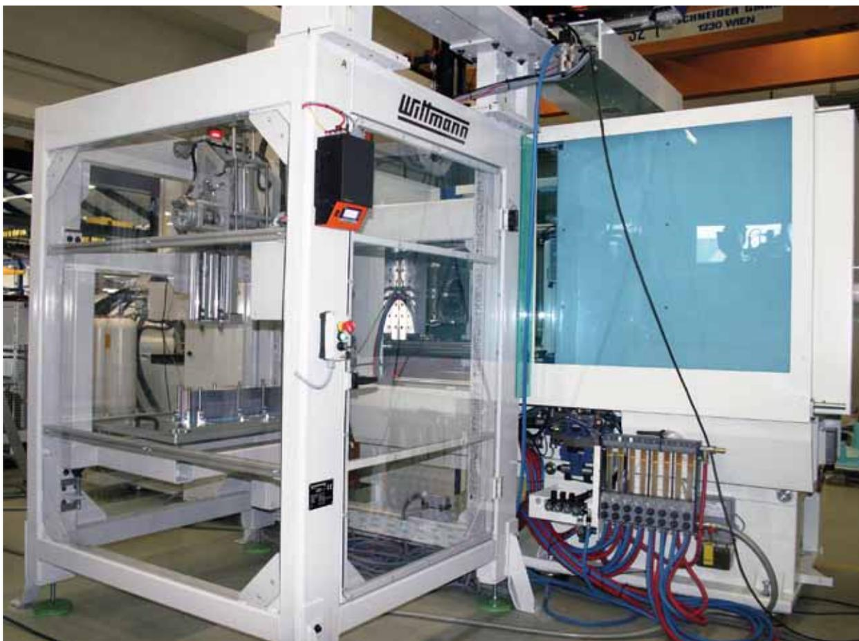
Die Ansicht einer der fertiggestellten Arbeitszellen bei Tea Plast zeigt die TM Spritzgießmaschine von WITTMANN BATTENFELD und den WITTMANN W832 IML-Roboter.
