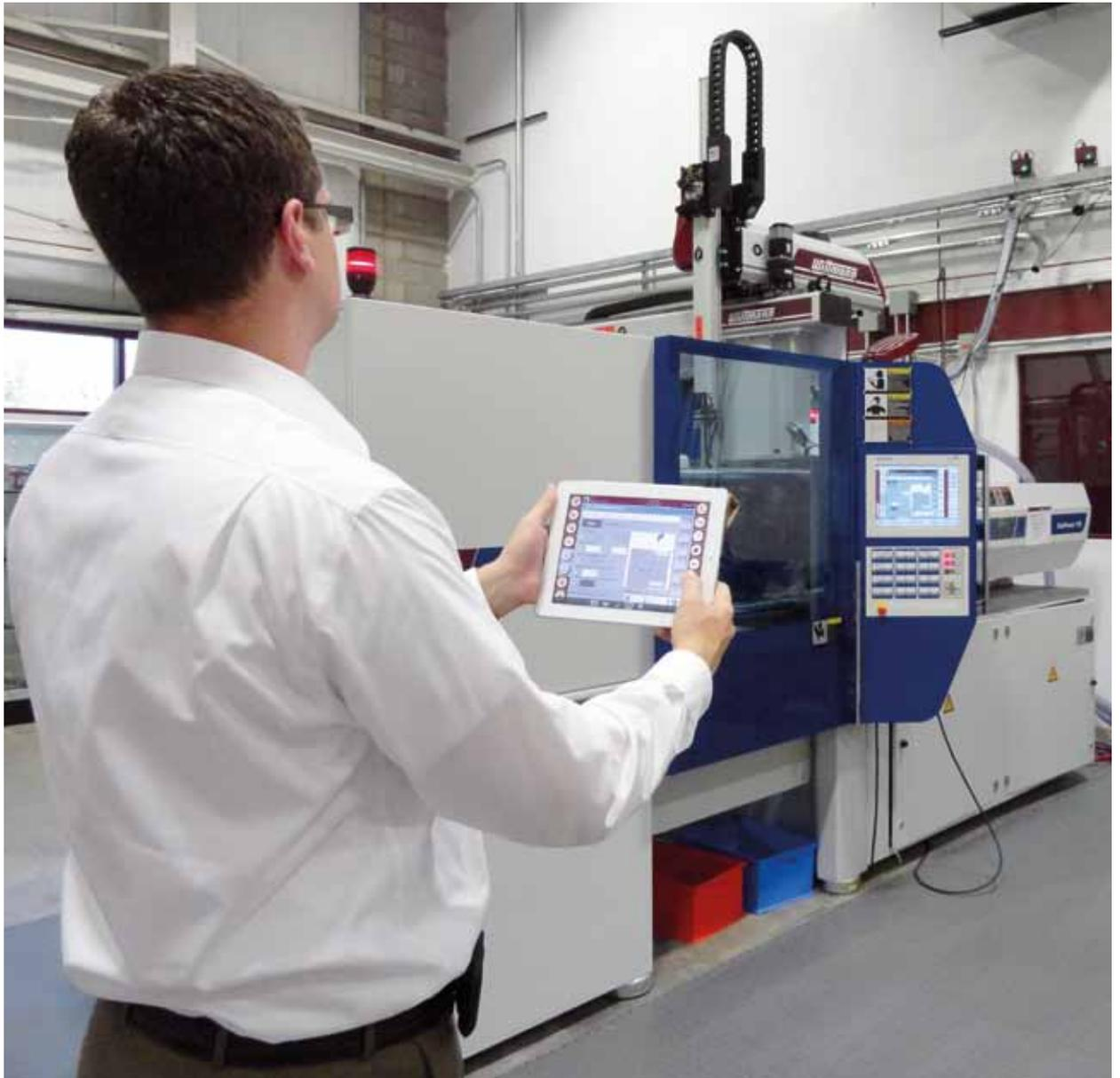
*Uneingeschränkter Fernzugriff: Anpassung der Parameter einer in Betrieb befindlichen WITTMANN BATTENFELD Spritzgießmaschine unter Verwendung eines iPad.*
