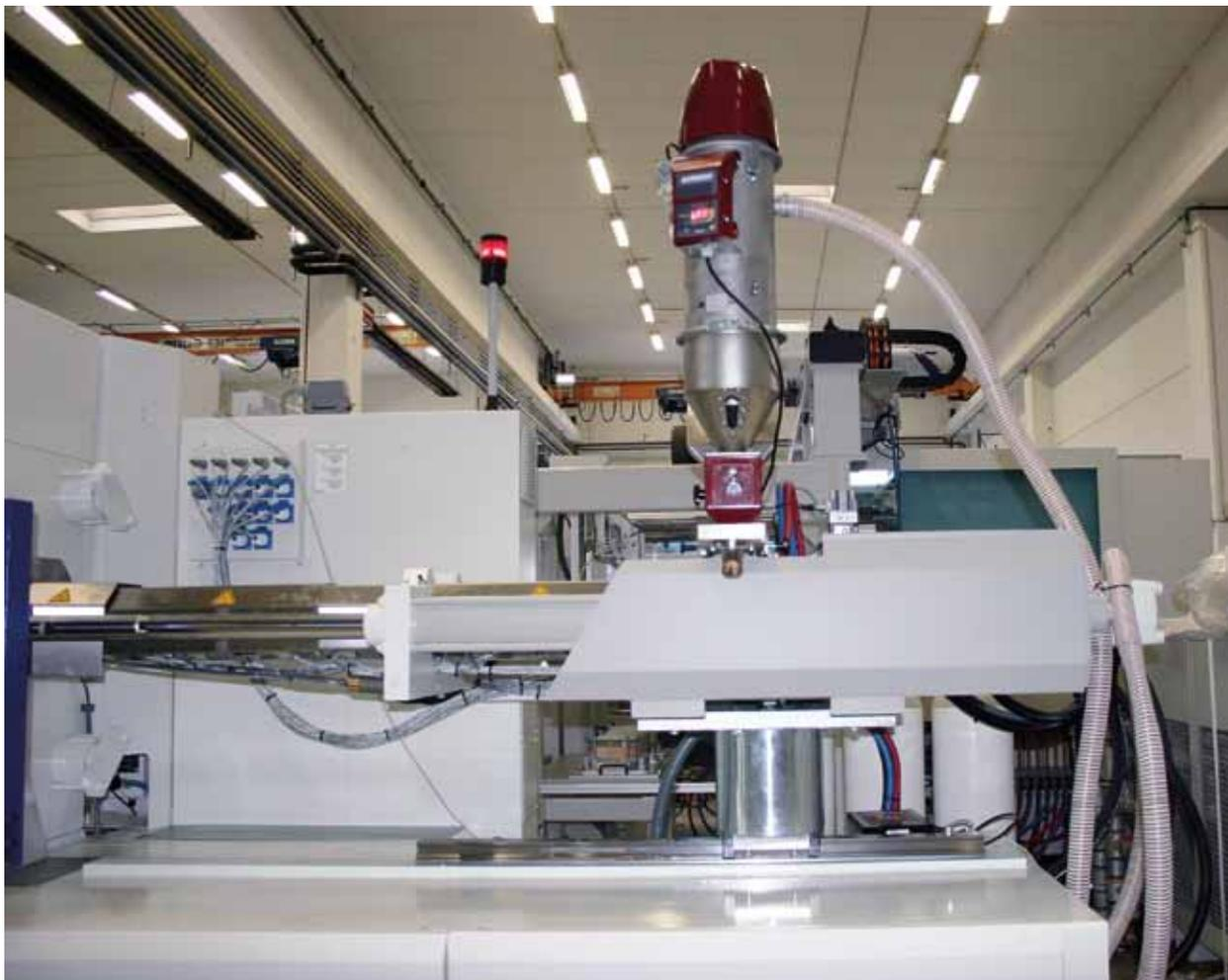
Die jeweils auf den Spritzgießmaschinen montierte Fördereinheit, bestehend aus einem FEEDMAX S3 und einem DOSIMAX MC Basic von WITTMANN.
