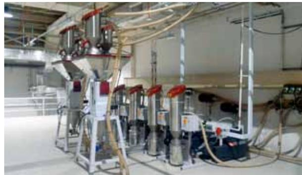
*GRAVIMAX Dosiergeräte, auf Podesten, rechts dahinter Filterstationen und Vakuumpumpen.*
