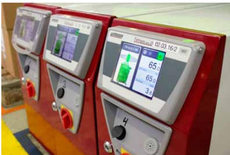
ten Pumpen ausgestattet. Durch ihre grundsätzlich gegebene hervorragende Integrierbarkeit in bestehende Anlagen, ihre hohe Temperiergenauigkeit sowie die vorhandenen Möglichkeiten zur Durchflussmessung und zur Drucküberwachung, leisten diese Geräte einen wesentlichen Beitrag zu umfassender Produktionssicherheit.
