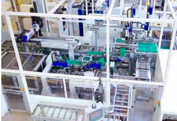
*Die Qualitätskontrolle (12 Kameras, ein Spiegelsystem) erstellt von jedem Teil fünf Bilder und wertet sie aus. Das System erstellt 64 x 5 Bilder innerhalb des Zyklus! Das Auswertesystem identifiziert 23 unterschiedliche Fehlerarten.*
