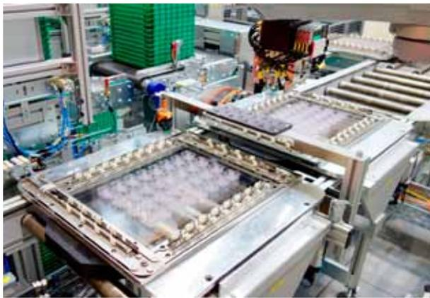
*Von den Transfer-Paletten werden die Teile in Trays abgelegt, diese gehen in Speditions-Boxen zur Waschmittel-Abfüllung.*
