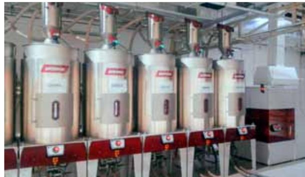
*DRYMAX E1200 Batterietrockner mit SILMAX Trockensilos.*
