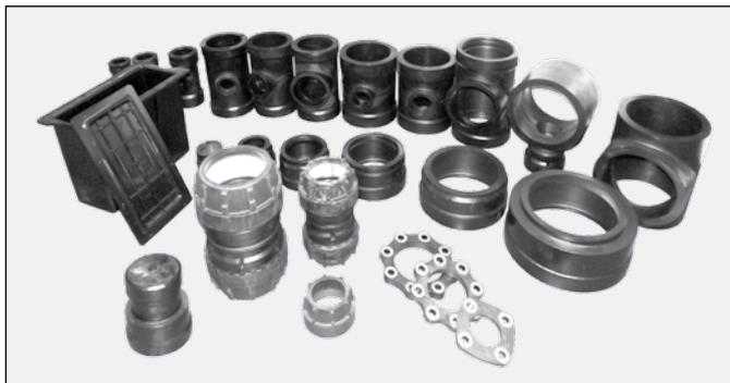
konnte einer eleganten Lösung zugeführt werden. Alle Fittings wurden in mehrere Teile zerlegt, die einzeln gespritzt werden konnten. Dieser Zugang erlaubte es schließlich, über 100 unterschiedliche Modelle zu produzieren, und dafür nur einige wenige Werkzeuge einzusetzen, denn die einzelnen aus PE bestehenden Teile konnten variabel kombiniert und dann miteinander verschweißt werden. Auf diese Weise gelangte Prince zu einer großen Vielfalt beim Endprodukt.
