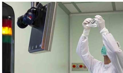
Die Produkte werden unter Schutzatmosphäre verpackt. Auf Ultraschallreinigung und Trocknung folgt die Erstverpackung (Blister, Tyvek- oder Vakuumbbeutel), die zuverlässig vor Verunreinigungen von außen schützt. Nach der Etikettierung und dem Verpacken der Blister in Schachteln werden die Schachteln durch eine transparente Schrumpffolie geschützt und zur Sterilisierung verschickt.
