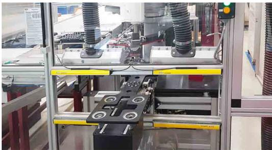
*Bild links: Bereitstellungs-Station für verpresste Inserts.*
