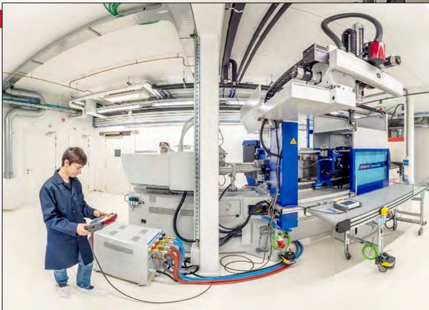
Ansichten der von WITTMANN BATTENFELD Benelux NV gelieferten EcoPower Arbeitszelle in der B-PHOT Forschungsabteilung der Vrije Universiteit Brussel mit W818 Roboter, variothermem Tempro plus D180 Temperiergerät und Aton plus VS Segmentradrockner mit Materialförderung. Alle Geräte sind über Wittmann 4.0 mit der Spritzgießmaschine verbunden.
