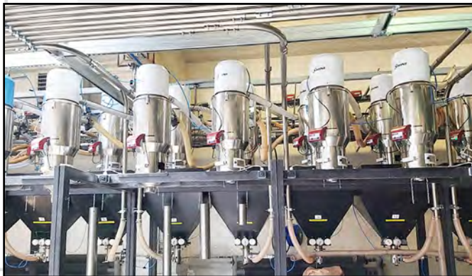
Beispiele für die Integration von Peripheriegeräten unterschiedlicher Hersteller: Fördergeräte mit Steuerungskomponenten von WITTMANN (links) und WITTMANN Materialtrockner mit jeweils unterschiedlichen Fördergeräten auf den Trocknungssilos.
