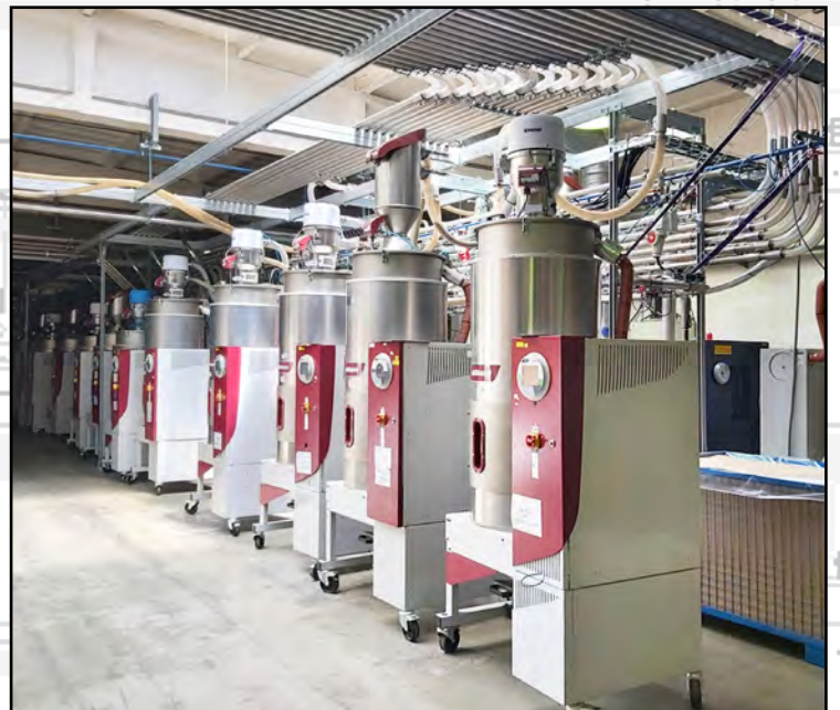
Beispiele für die Integration von Peripheriegeräten unterschiedlicher Hersteller: Fördergeräte mit Steuerungskomponenten von WITTMANN (links) und WITTMANN Materialtrockner mit jeweils unterschiedlichen Fördergeräten auf den Trocknungssilos.
