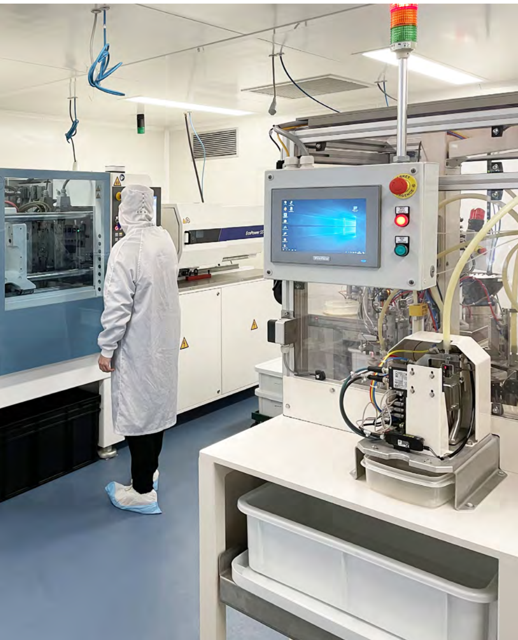
Ansicht des Reinraums von Sedatelec in Irigny, mit der von WITTMANN BATTENFELD France SAS gelieferten elektrischen EcoPower 55 Spritzgießmaschine. Die hier für das Inline-Recycling zum Einsatz kommende Mühle ist auf dem Bild aufgrund ihrer besonderen Installationsweise unter der Spritzgießmaschine nicht zu sehen.
