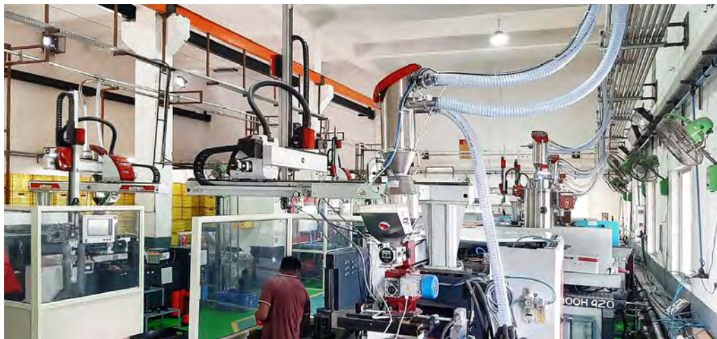
Die Automat Irrigation Produktion in Haridwar, Uttarakhand: Das Zusammenspiel von Automatisierung und Materialfördersystem führte zu einer entscheidenden Produktivitätssteigerung und letztendlich zu einer spürbaren Reduzierung der Produktionskosten.
