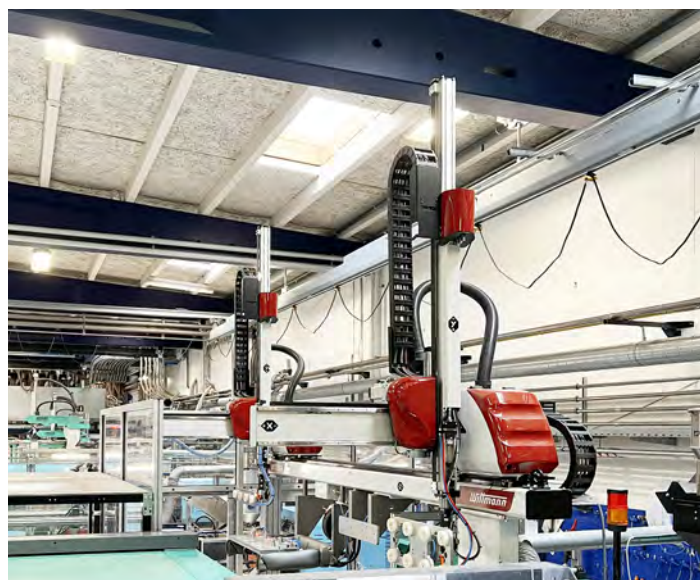
Ansichten der Tandem-Automatisierungslösung bei SP Moulding in Juelsminde, Dänemark, bestehend aus zwei WITTMANN W918T Robotern, montiert auf einer Z-Achse.
