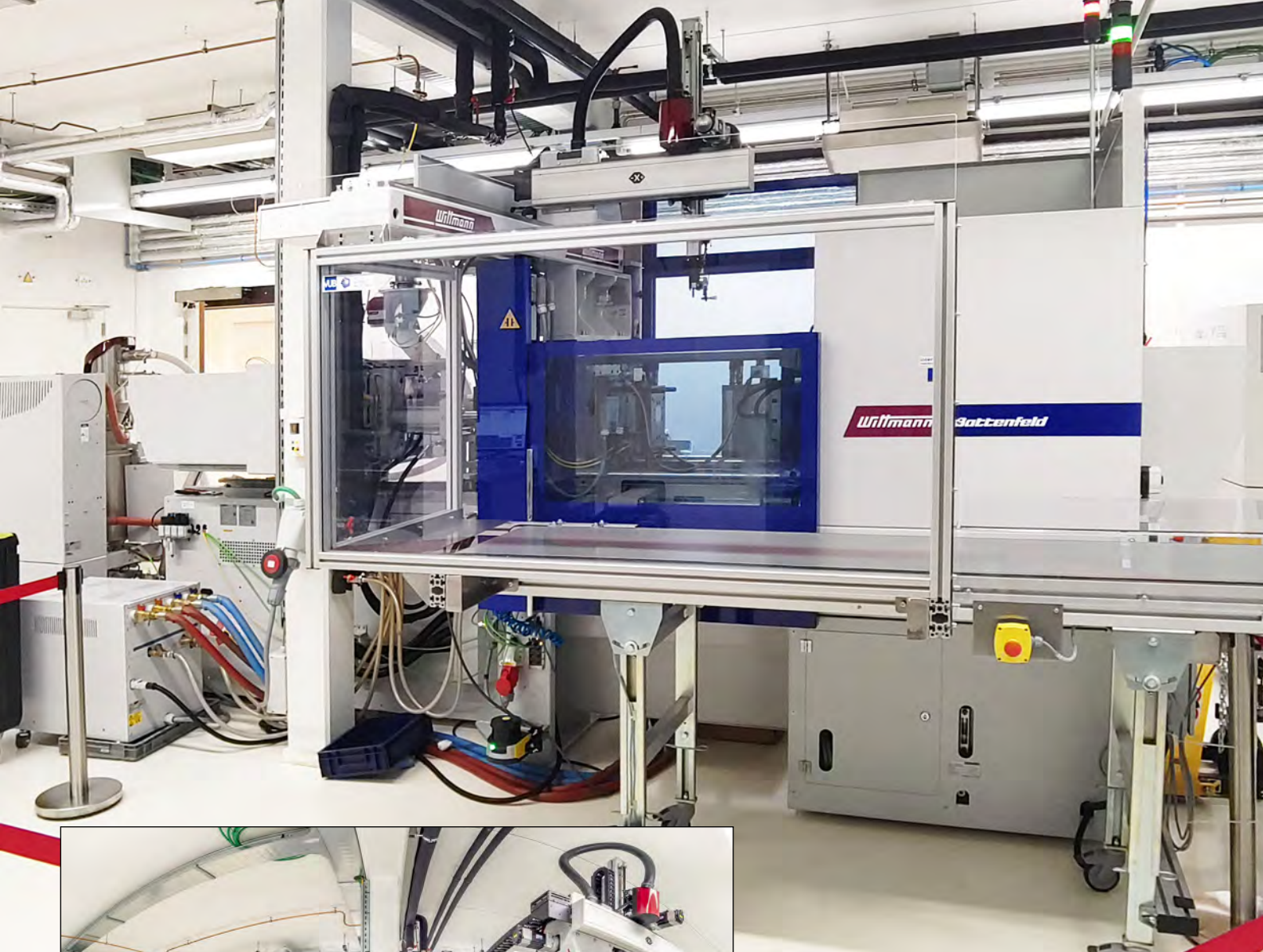
Ansichten der von WITTMANN BATTENFELD Benelux NV gelieferten EcoPower Arbeitszelle in der B-PHOT Forschungsabteilung der Vrije Universiteit Brussel mit W818 Roboter, variothermem Tempro plus D180 Temperiergerät und Aton plus VS Segmentradrockner mit Materialförderung. Alle Geräte sind über Wittmann 4.0 mit der Spritzgießmaschine verbunden.
