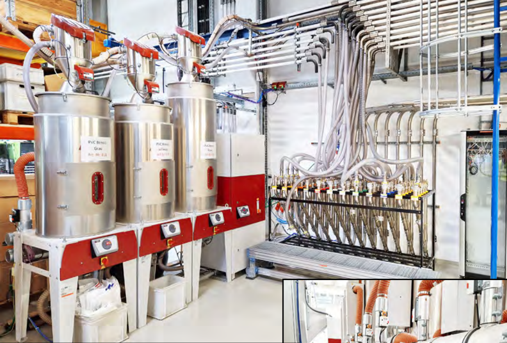
Die beiden Kupplungsbahnhöfe der Anlage mit RFID-Kodierung (oben) und Farbkodierung der Materialkupplungen.
