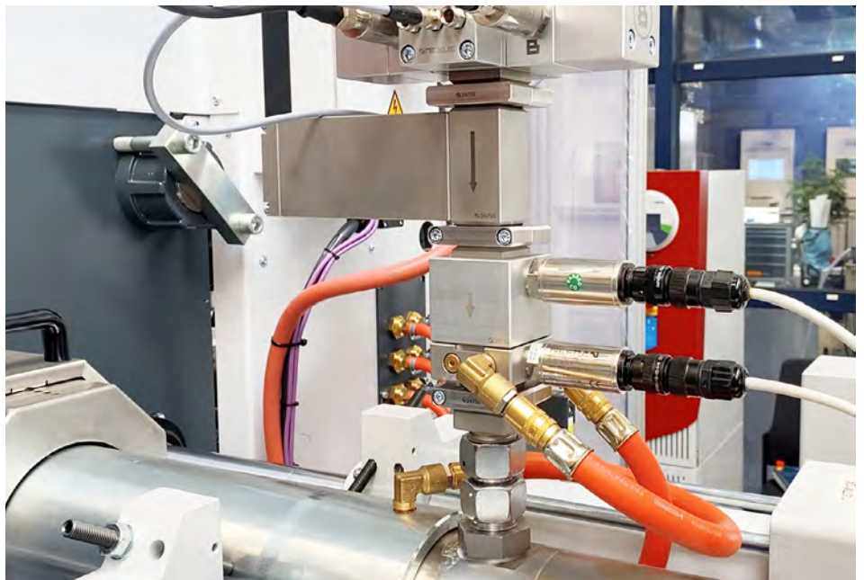
Vorrichtung zur Differenzdruckmessung beim Materialeinzug.
