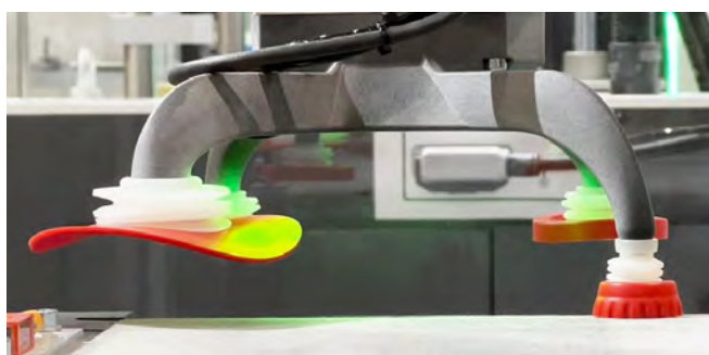
Vorrichtung zur Differenzdruckmessung beim Materialeinzug.
