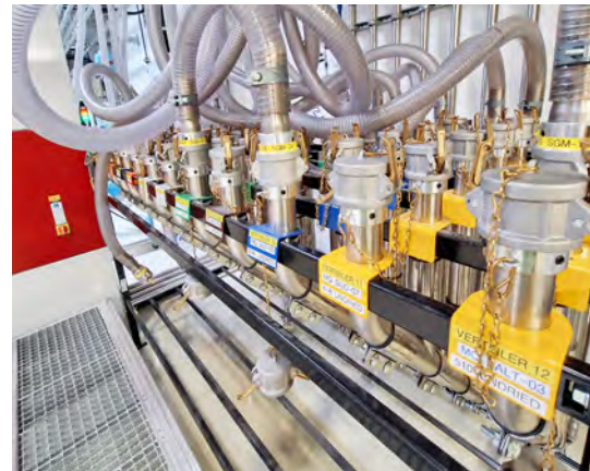
Ansichten der Praher Trocknungsanlage in Schwertberg, Oberösterreich. Insgesamt wurden verbaut: 2 Drymax 900 Batterietrockner mit FC plus (verbrauchsorientierter Trocknersteuerung), 1 Drymax 300 FC Trockner, 21 Silmax Trocknungssilos mit Volumina von 150 bis 800 Litern und 89 Feedmax Fördergeräte.
