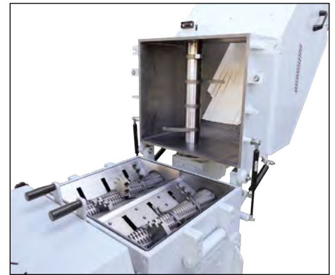
Die S-Max Dual 6 und ihre offene Mahlkommer mit der zusätzlichen Einzugswalze im schwenkbaren Teil des Materialtrichters.
