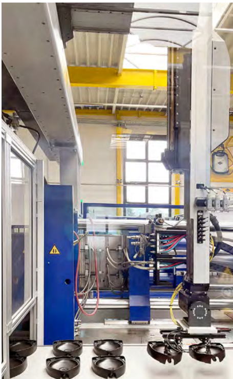
Der WITTMANN W831 Roboter legt Bauteile für 3-bar-Sprühgeräte auf dem Förderband ab. (Foto: MESTO)
