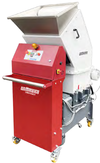
Die S-Max Dual 6 und ihre offene Mahlkommer mit der zusätzlichen Einzugswalze im schwenkbaren Teil des Materialtrichters.
