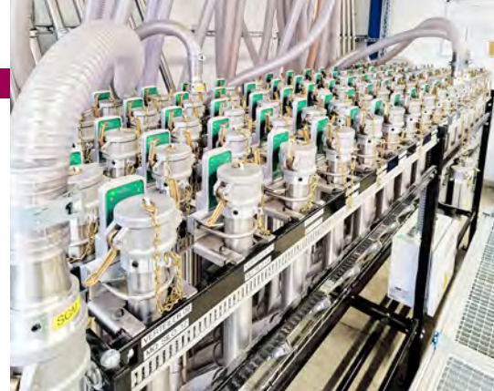
Die beiden Kupplungsbahnhöfe der Anlage mit RFID-Kodierung (oben) und Farbkodierung der Materialkupplungen.
