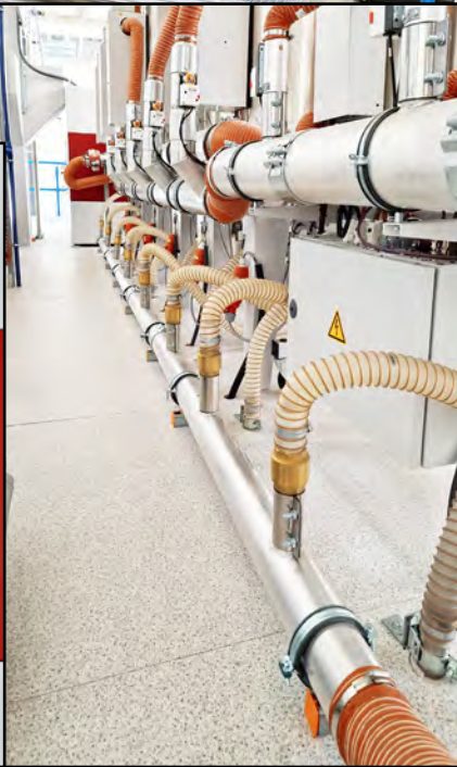
Ansichten der Praher Trocknungsanlage in Schwertberg, Oberösterreich. Insgesamt wurden verbaut: 2 Drymax 900 Batterietrockner mit FC plus (verbrauchsorientierter Trocknersteuerung), 1 Drymax 300 FC Trockner, 21 Silmax Trocknungssilos mit Volumina von 150 bis 800 Litern und 89 Feedmax Fördergeräte.
