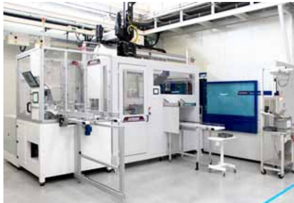
Komplette Arbeitszelle bei Stiplastics Healthcaring in Saint-Marcellin, Frankreich: WITTMANN BATTENFELD SmartPower Spritzgießmaschine mit 300 t Schließkraft, WITTMANN W832 pro Roboter und IML-Anlage.
