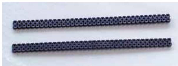
**Stiftleisten mit Stiftkontakten für elektronische Leiterplatten. Die Produktion dieser Teile aus einem Hochleistungskunststoff (Polyamid 4,6 mit 30 % Glasfaser) verlangt umfassende Prozessüberwachung.**
