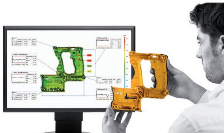
Soll-Ist-Vergleich mit statischer Auswertung (GOM-Professional Inspect)
