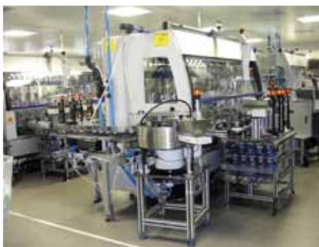
*Ein 32-fach-Vakuumgreifer entnimmt die 0,02 g leichten Zahnräder. Der Linearroboter bewegt den Vakuumgreifer im Acht-Sekunden-Zyklus.*
