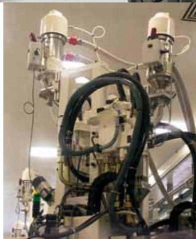
Die Produktionsanlage bei WEIDMANN in Bad Ragaz. Kleines Bild: Die vertikalen Spritzeinheiten für den Zweikomponenten-Spritzguss. (Fotos: WEIDMANN)
