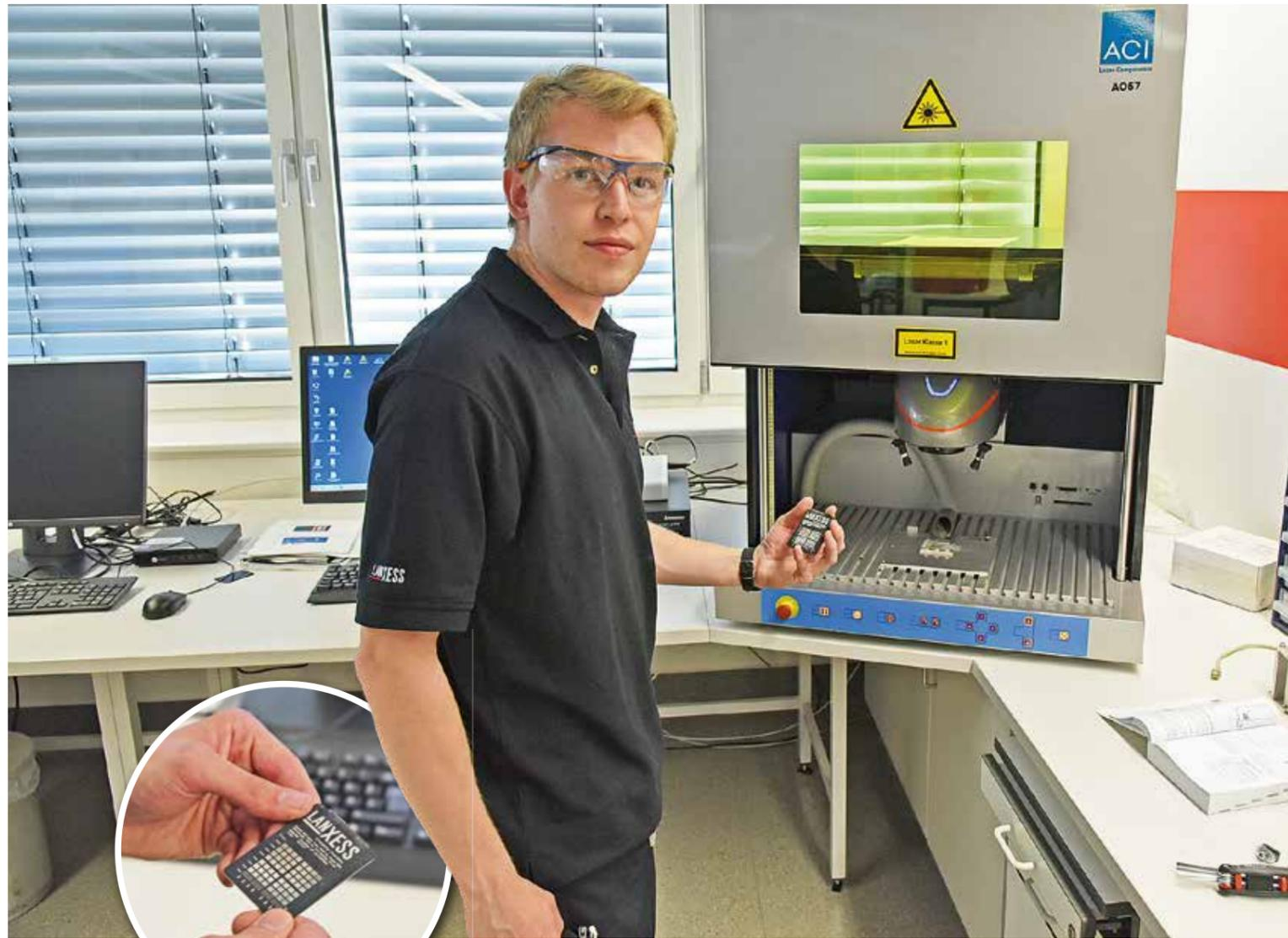
**Laserbeschriftung – Wichtiges Anwendungsfeld in der Industrie: die Laserbeschriftung. Wie gut sich ein Kunststoff per Laserstrahl beschriften lässt, wird hier geprüft. Die Compounds sind durch entsprechende Additive dafür vorbereitet.**
