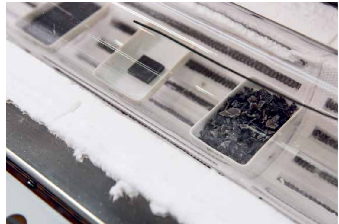
Abbildung 2: Versuchsaufbau im Klappofen zur Durchführung der Pyrolyse – hier von thermoplastischen FVK verschiedener Geometrien.
