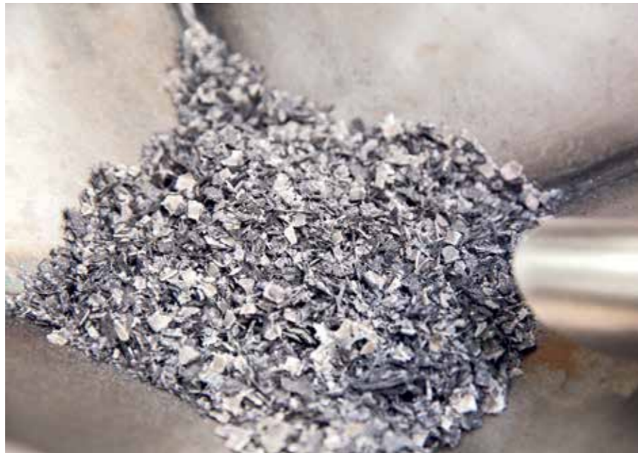
Abbildung 1: Mahlgut aus einem hybriden duromeren Faserverbundkunststoff mit Carbon- und Naturfaserverstärkung. © Foto Fraunhofer WKI | Marek Kruszewski
