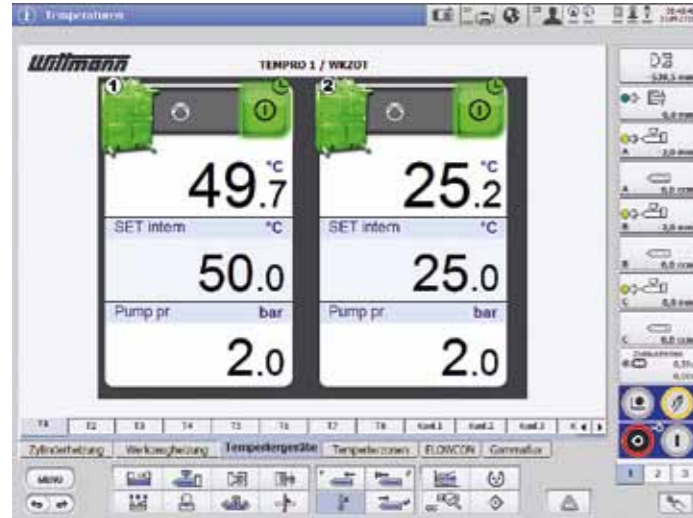
Abb. 2: Spritzgießmaschine als Schaltzentrale für Temperiergeräte TEMPRO plus D
