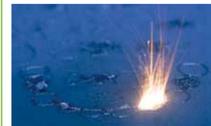
Bauprozess des Laser-Sinterns bei Herstellung von Dentalkronen und Brücken aus EOS Co-baltChrome SP2 – Der Laserstrahl trifft auf das Pulverbett
