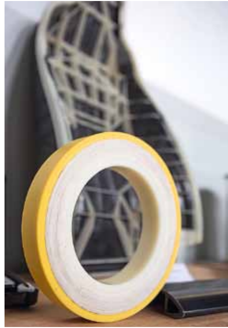
Querschnitt eines Mehrlagen-Wickelrohres für die Öl- und Gas-Industrie (Vordergrund) und Tape-basierte CAMISMA-Sitzstruktur (Hintergrund)
