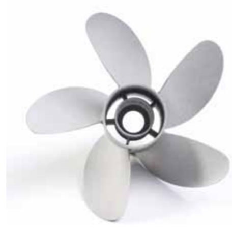
Antriebspropeller für Rennboote als verkleinertes Modell zur Stromungsmessung
