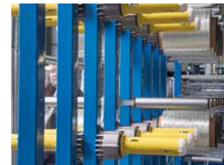
Pilotanlage zur Direkt-Schmelze-Imprägnierung von Thermoplastische UD-Tapes
