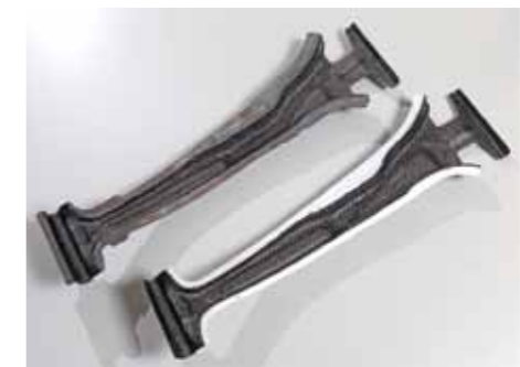
B-Säule als Demonstrator der PU-basierten Prepregs für FVK-Metal-Hybridstrukturen
