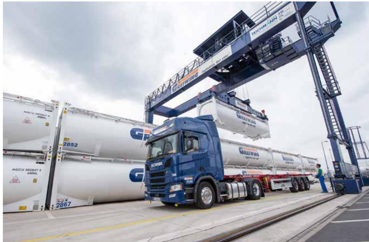
Für das Containerhandling am Standort Duisburg kann GREIWING unter anderem auf einen 45-Tonnen-Portalcrane zurückgreifen.
