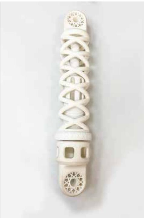
Das Besondere an diesem komplex geformten, 3D-gedruckten Stoßdämpfer ist neben seiner hohen Funktionalität die Fertigung einzelner Teile aus Polycarbonat-Filament, pulverförmigem thermoplastischem Polyurethan (TPU) bzw. flüssigem Polyurethanharz und mit Hilfe von drei verschiedenen 3D-Druck-Verfahren.
