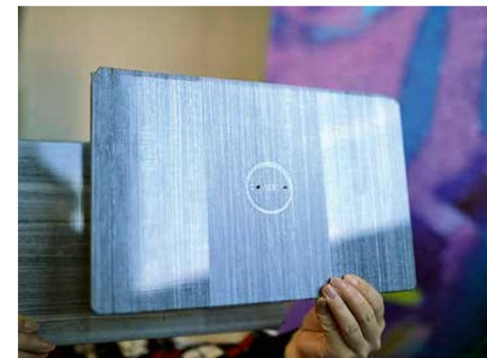
Eine mögliche Anwendung für endlosfaserverstärkte, thermoplastische Composites (CFRTP) der Marke Maezio™ sind leichtgewichtige und sehr dünne Laptop-Deckel mit neuartigen optischen Oberflächen-Effekten.
