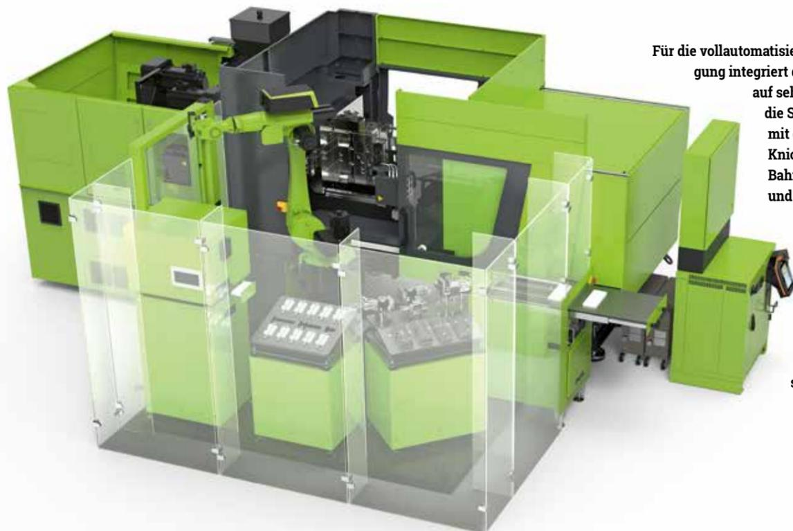
**Für die vollautomatisierte Variantenfertigung integriert die Systemlösung auf sehr kompakter Fläche die Spritzgießmaschine mit einem ENGEL easix Knickarmroboter, einen Bahnhof für die Greifer und Werkzeugeinsätze, einen Laserprinter, eine Montagevorrichtung und eine Fördereinheit zum Ausschleusen der einsatzbereit montierten Messchieber.**
