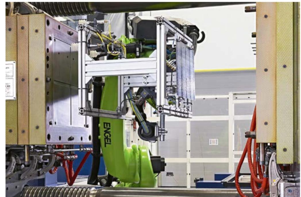
Der ENGEL easix Knickarmroboter übernimmt das Handling sowohl der Faserpreforms als auch der Fertigteile zwischen IR-Ofen, Schließeinheit und Ablageband.
