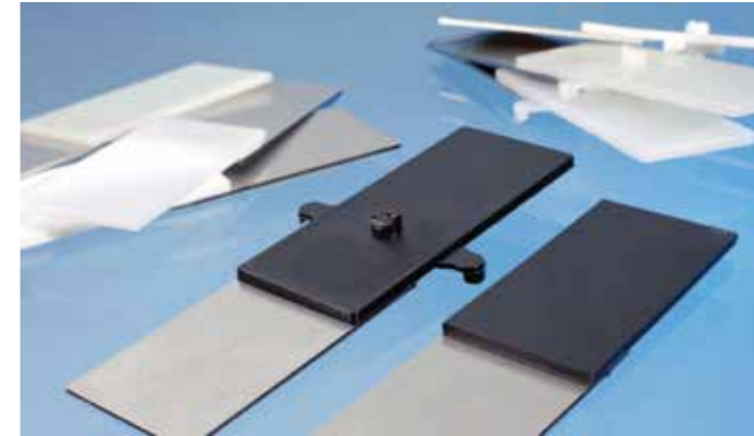
Bild 3: Realisierte Hybridverbindung mittels Spritzguss mit unterschiedlichen Thermoplasten und Füllstoffen.
