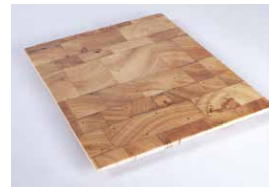
Bild 3: Sandwichplatte: Beispiel mit Balsa Holz
