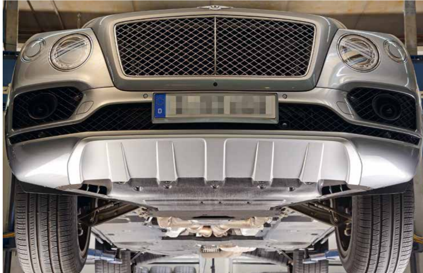
Eine innovative Materiallösung für widerstandsfähige Unterbodenverkleidungen setzt auf Verbundwerkstoffe der Marke Tepex. Mit ihrer Hilfe werden nahezu unzerstörbare Motorraumverkleidungen sowie Tank- und Tunnelabdeckungen hergestellt, die bereits unter anderem im Bentley Bentayga zum Einsatz kommen.
