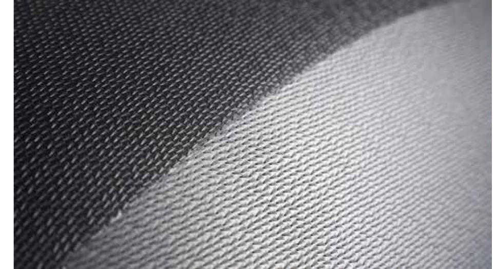
Bild 2: Bionische Oberfläche nach dem Vorbild eines Mako-Hais.
